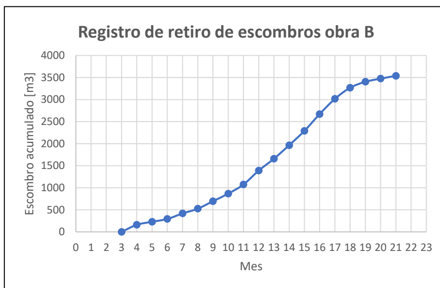
Ilustración 3.7. Registro de retiro de escombro, Obra B. Fuente: elaboración propia en base a EBCO S.A.
