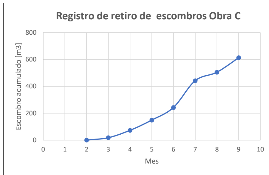
Ilustración 3.10. Registro de retiro de escombros, Obra C. Fuente: elaboración propia en base a EBCO S.A.
