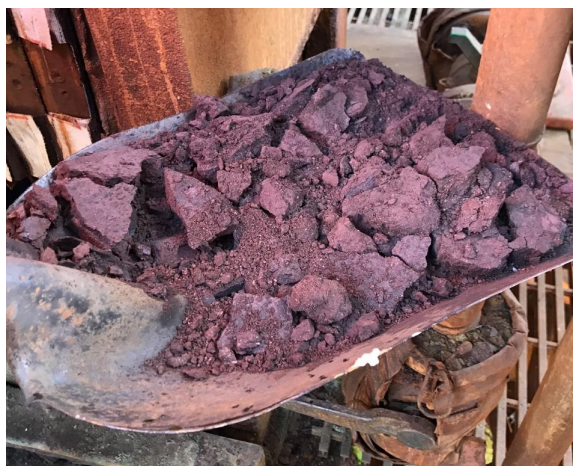
Figura 3.1: Cemento de cobre extraído del reactor de Minera Los Pelambres.
