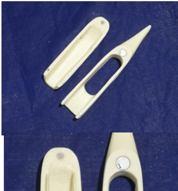
Fig.63 Imanes de neodimio en prototipo
