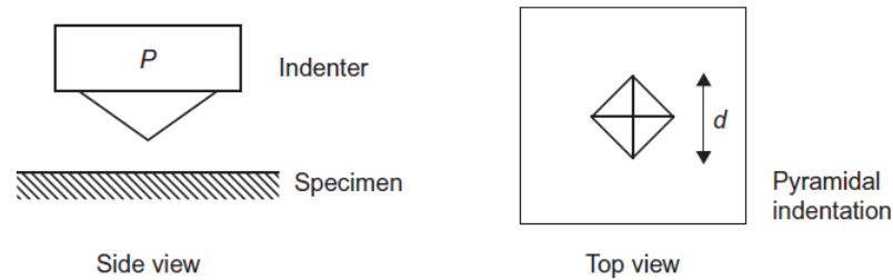
Figura 2.9: Esquema de indentación. [28]
