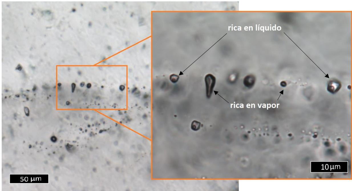
Figura 34. Arreglo de inclusiones fluidas primarias con coexistencia de inclusiones ricas en líquido e inclusiones ricas en vapor. Se hospedan en cristales de cuarzo euهدral y representan procesos de ebullición.
