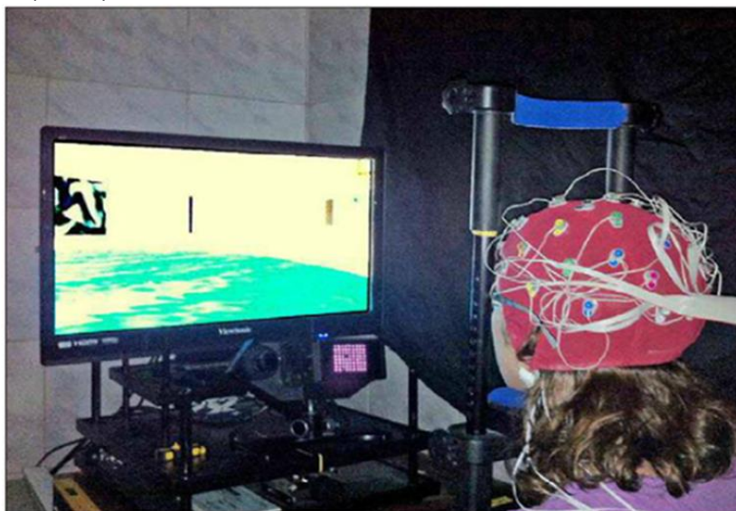
Figura 4. Registro electroencefalográfico acoplado a un sistema de registro de movimientos oculares Eye-Tracker y una tarea de memoria espacial virtual tipo Morris Water Maze .
