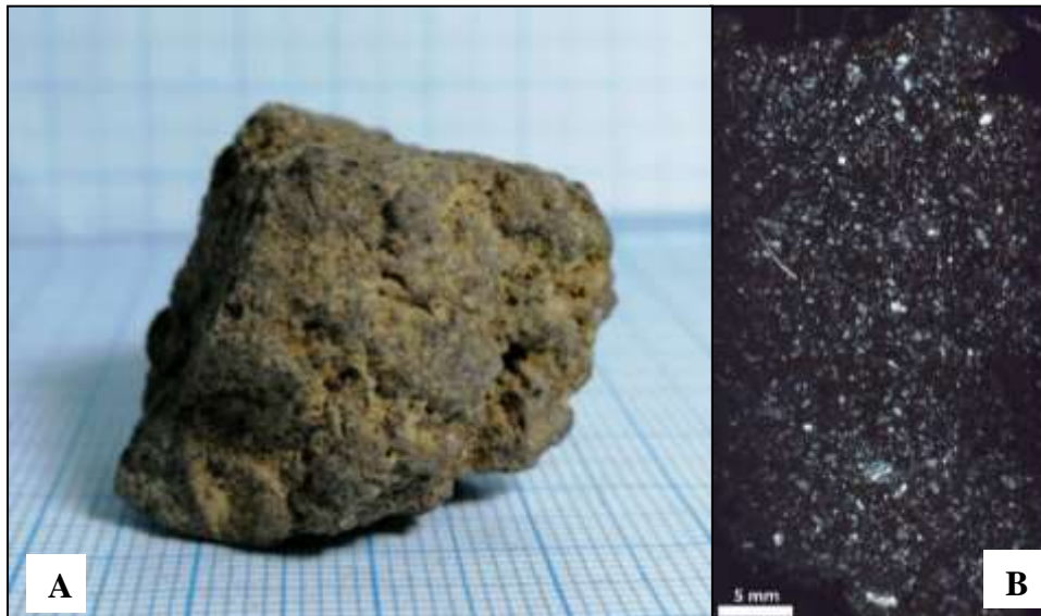
Figura 21: Escoria gris C1 del depósito de caída de la erupción de 1893. A: Fragmento a muestra de mano. B: Corte transparente en nícoles cruzados.
