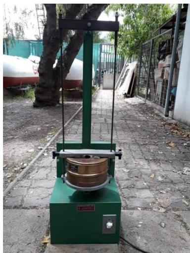
La muestra de suelo base (Suelo Alhué) fue recolectada y secada en bandejas de plástico a temperatura ambiente, para luego ser tamizada con tamiz < 2 mm como muestra la Figura 19 (Humboldt Mfg. USA Standard Sieve); el cual se almacenó en frascos plásticos de 1 kg para su posterior preparación con las modificaciones correspondientes y sus futuros análisis.
