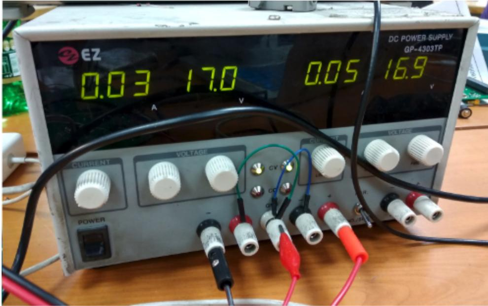
Figura 4.2: Foto de la fuente de alimentación que energiza la tarjeta Planar Langmuir Probe. Necesita ser alimentada con  $-17[V]$ ,  $0[V]$  y  $17[V]$ . Habitualmente consume  $0.03[A]$  en la terminal negativa y  $0.05[A]$  en la terminal positiva.
