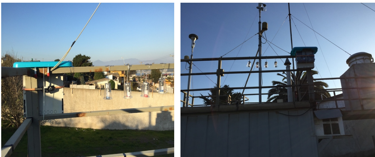
Figura 13 A la izquierda, fotografía de plataforma LoV-IoT 1 junto con 2 tubos pasivos de SO 2 y 2 de NO 2 en Estación Quintero. En esta estación se incorpora tubos pasivos blancos de cada gas en interés. A la derecha, fotografía de Plataforma LoV-IoT 1, tubos pasivos y cabezales de instrumentos oficiales de medición perteneciente a Estación Quintero.
