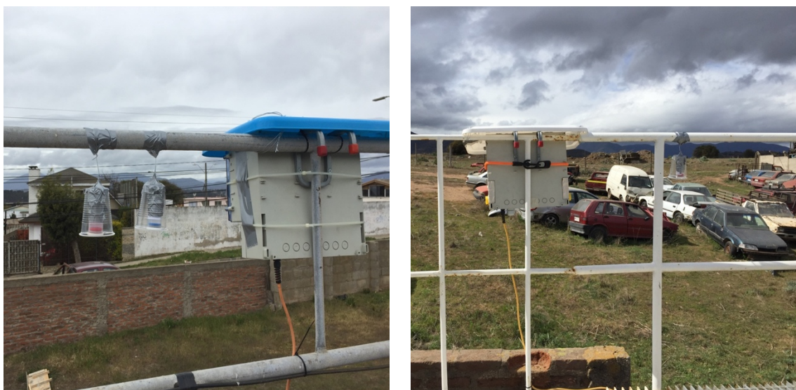
Figura 16 A la izquierda una fotografía de Plataforma LoV-IoT 1 y tubos pasivos de \text{NO}_2 y \text{SO}_2 en Estación Quintero. A la derecha una fotografía de Plataforma LoV-IoT 2A ubicada en la Estación Puchuncaví, junto con tubo pasivo de \text{NO}_2 .
