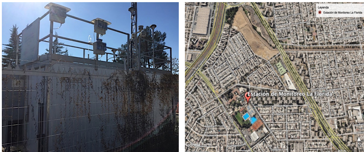
Figura 10 A la izquierda, fotografía de Estación La Florida, se observan las plataformas ubicadas adyacentes a cabezales de los equipos de monitoreo oficial. A la derecha, mapa que indica ubicación de Estación de Monitoreo de Calidad del Aire La Florida
