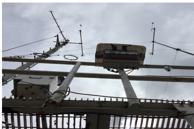
Figura 17 Fotografía de Plataforma LoV-IoT 2B, tubo pasivo y cabezales de instrumentos oficiales de medición perteneciente a La Greda.
