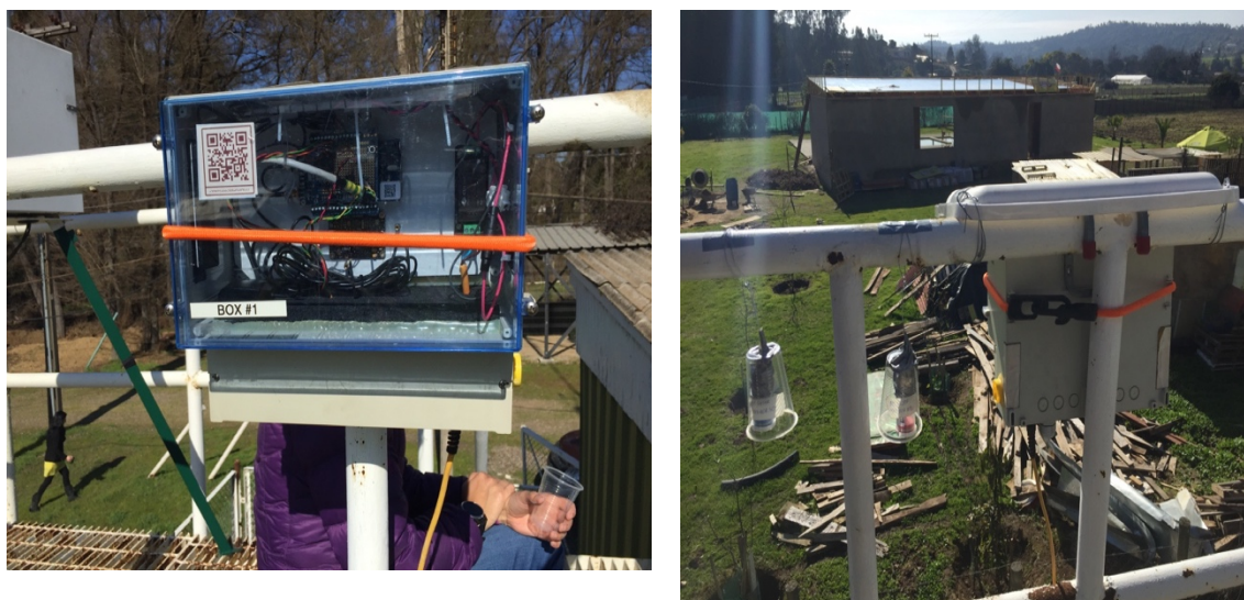
Figura 12 Fotografías de Plataforma LoV-IoT 2A ubicada en Estación Valle Alegre, junto con tubo pasivo de NO 2 .
