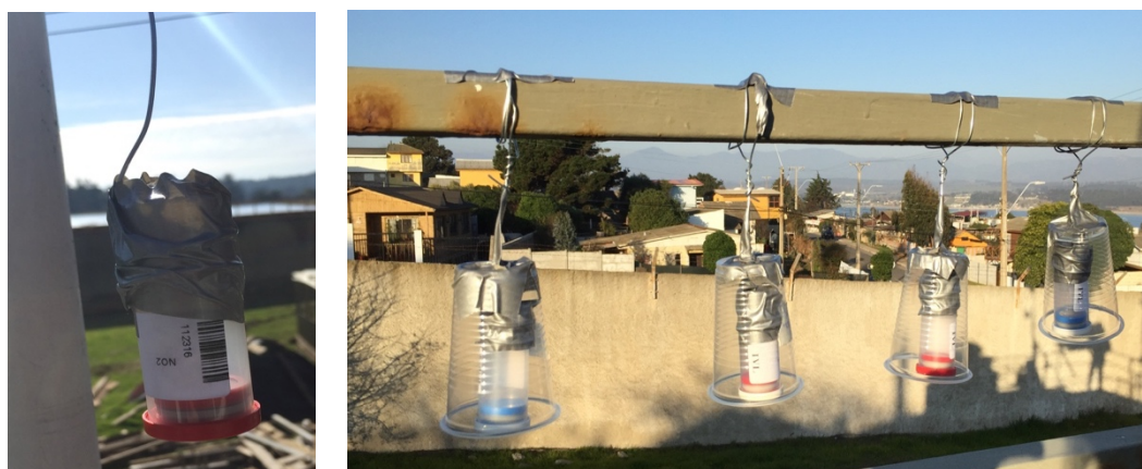
Figura 6 A la izquierda, fotografía de partes de un muestreador. A la derecha, una fotografía de un muestreador junto con el tubo que lo sostendrá.
