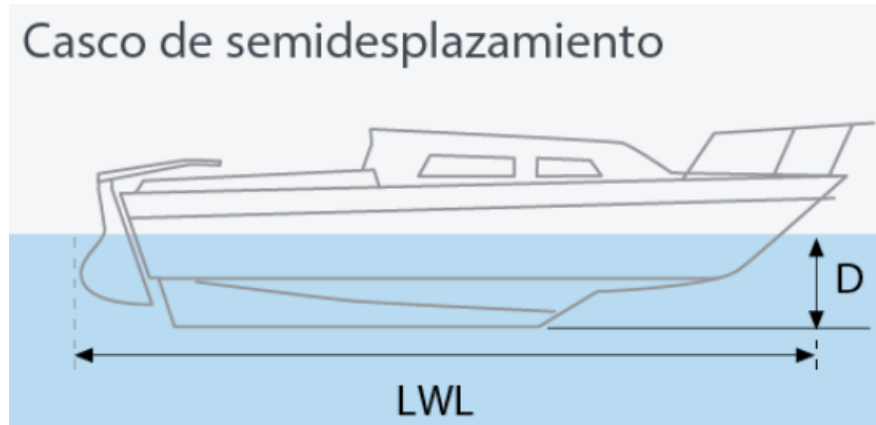
Figura 5.2: Medidas de caso tipo semidesplazamiento [16]
