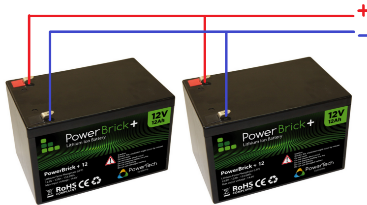
Figura 4.14: Conexión en paralelo, sistema de baterías
