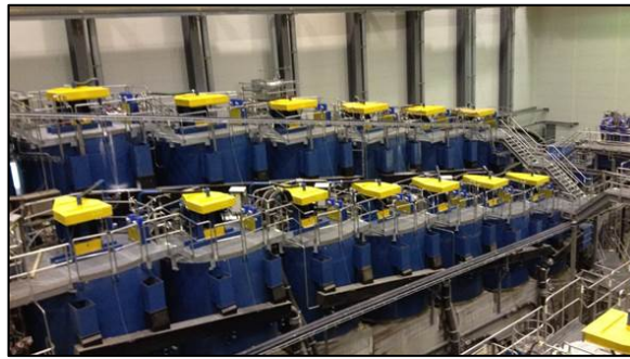
Ilustración 4: Celdas de flotación de base circular (Celdas de flotación RS TM - Metso).
