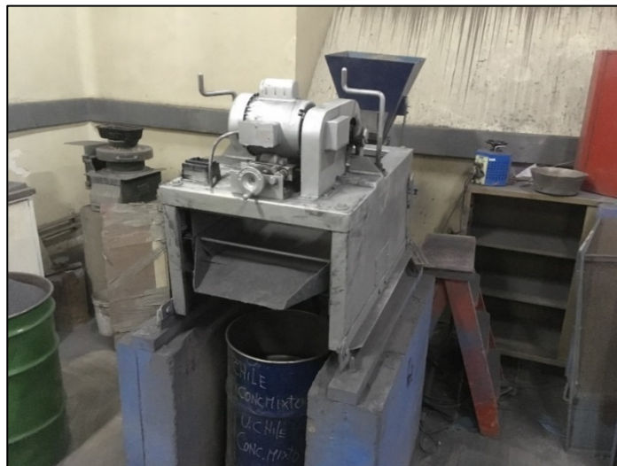
Ilustración 18: Harnero vibratorio, laboratorio.
