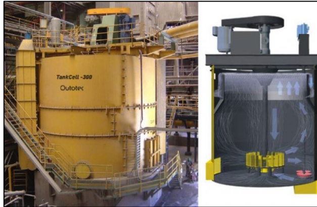
Ilustración 1: Celda flotación 300 m 3 (Outotec TankCell e300, Outotec Flotation Tankcell® e-Series).
