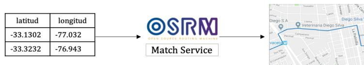
**Figura 4.1:** Diagrama de proceso de proyección de señales de GPS utilizando OSRM.
