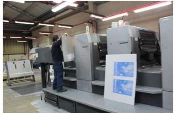
Ajuste de planchas metálicas en sección offset (Maq. Speedmaster)
