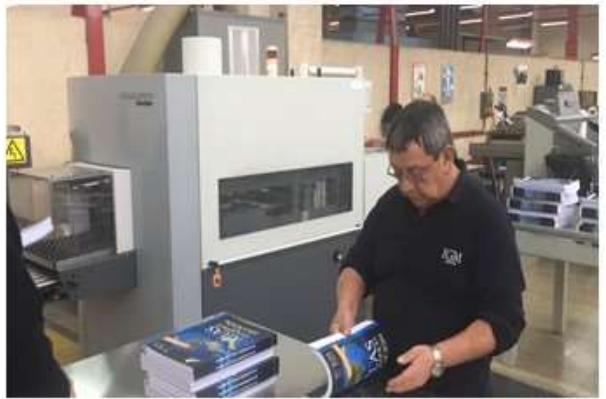
Corte en maquina Trilateral (Guillotina)
