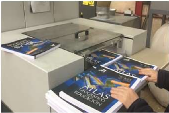
Corte en maquina Trilateral (Guillotina)
