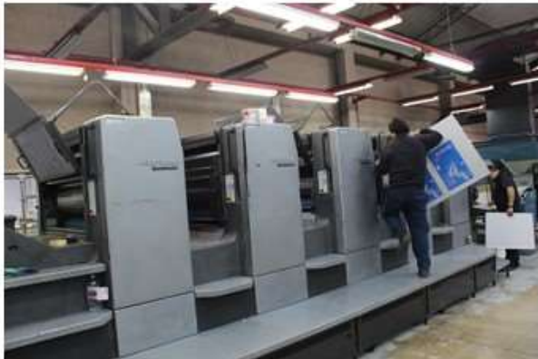
Ajuste de planchas metálicas en sección offset (Maq. Speedmaster)
