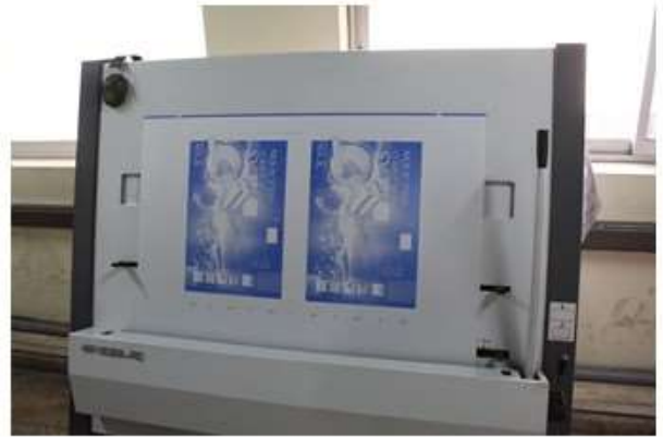
Quemado de planchas metálicas en CMYK
