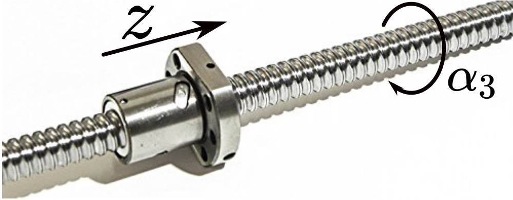
Figura 2.5: Husillo de bolas que transforma movimiento rotacional en movimiento angular
