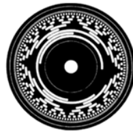
Figura 3.10: Encoders incremental (a) y absoluto (b)
