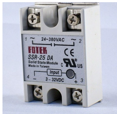
Figura 5.4: Relé de estado solido marca Fotek
