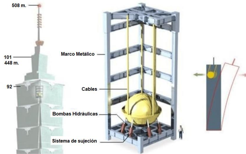
Figura 3-2: Sistema de DMS tipo péndulo, en Taipei 101 (Civil Engineering Forum, s. f.)
