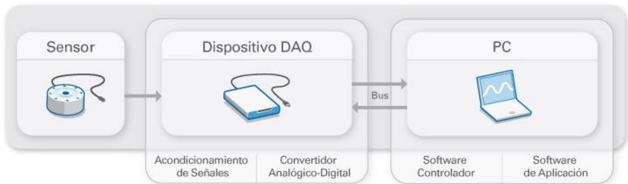
Figura 4-10: Esquema del funcionamiento de un Sistema DAQ (National Instruments, 2020).
