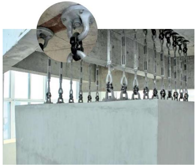
Figura 2-5: Masa del DMS, con su sistema de anclaje en detalle (Chapple, 2008).
