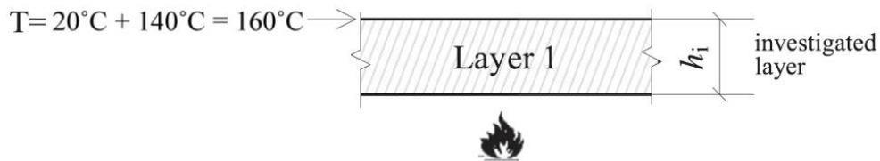
*Fig. 7-1. Configuración simulada para derivar valor básico de aislación. Ref. [3]*
