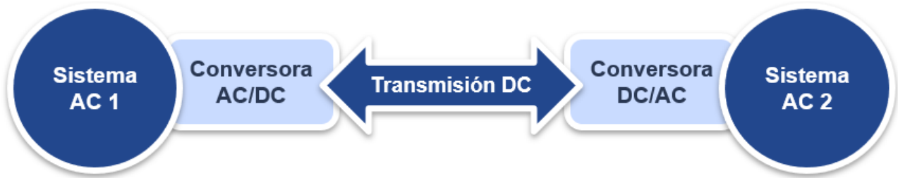
Figura 2.6: Conexión punto a punto.
