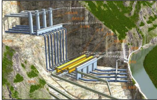
Ilustración 2.8. Vista Isométrica de los túneles de la Hidroeléctrica Jinping II, (W. Shiyong, X.Feng, L. Ribeiro e Sousa, 2010).
