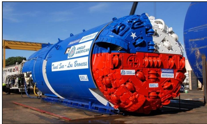
Ilustración 2.12. TBM Doble Escudo utilizada en la construcción del túnel Los Bronces, (P. Ruiz Parrilla, J. Espinoza, A. Palma, E. Fernández Gonzáles, 2012).
