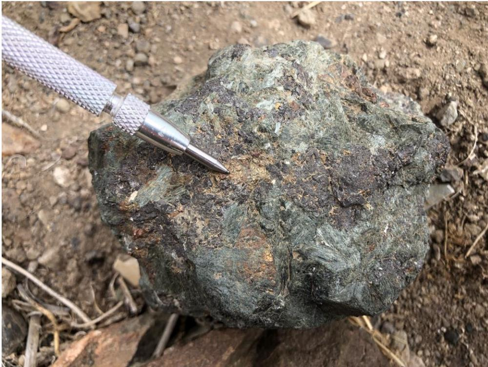
**Figura 18:** Muestra de mano donde se aprecian grandes cristales de actinolita (verde) intercrecida con magnetita y calcopirita.
