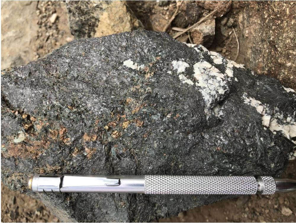
**Figura 17:** Muestra representativa de veta con magnetita-actinolita-apatito y calcopirita.
