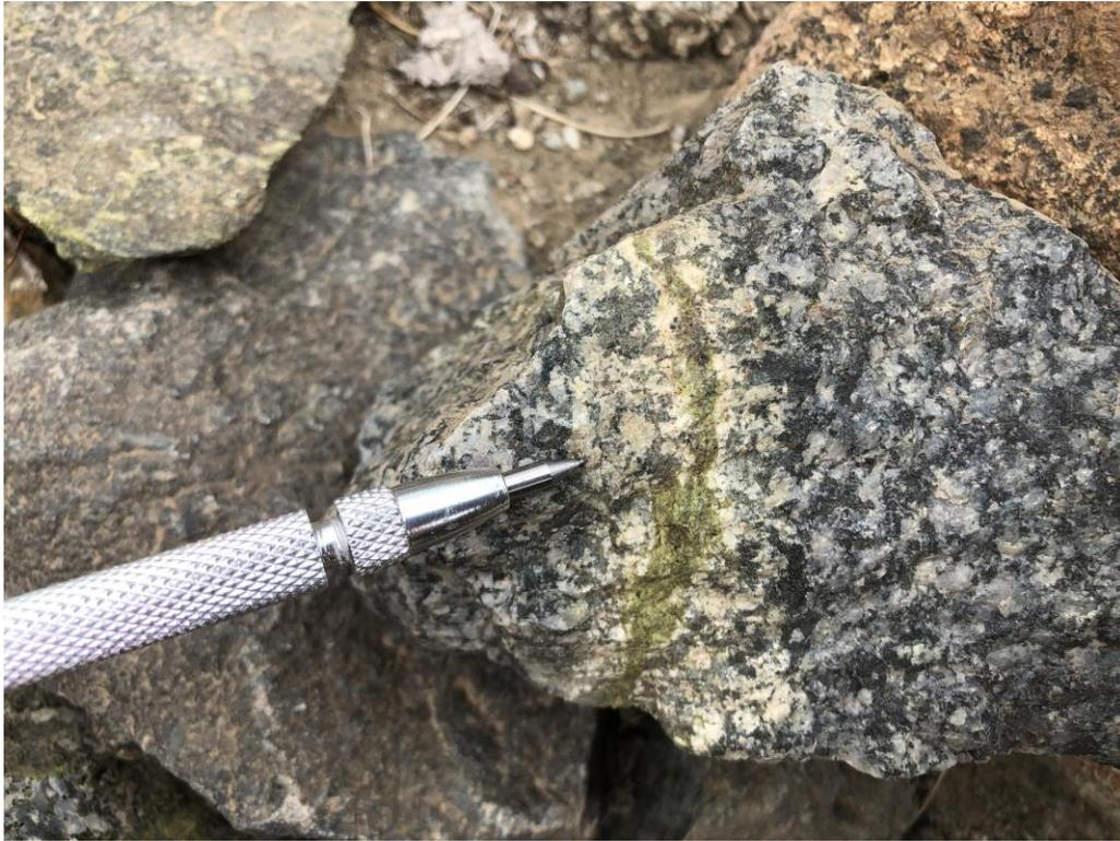
**Figura 16:** Muestra de intrusivo diorítico cortado por una vetilla de epidota con halo de albita.
