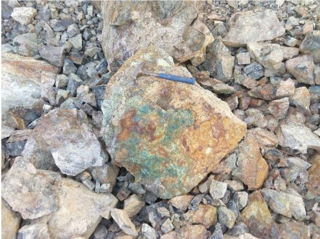
**Figura 13:** Roca representativa de la mineralización presente en la veta de la Figura 12, se observa oxidados verdes de cobre y limonitas.
