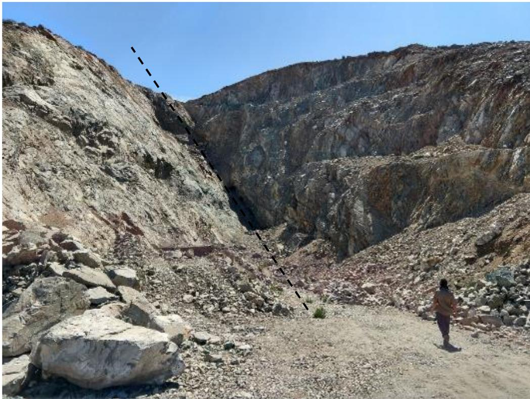
**Figura 11:** Imagen de una labor de extracción mineral al sureste del depósito, la línea punteada representa la orientación de la veta (N70°E/65°SW).
