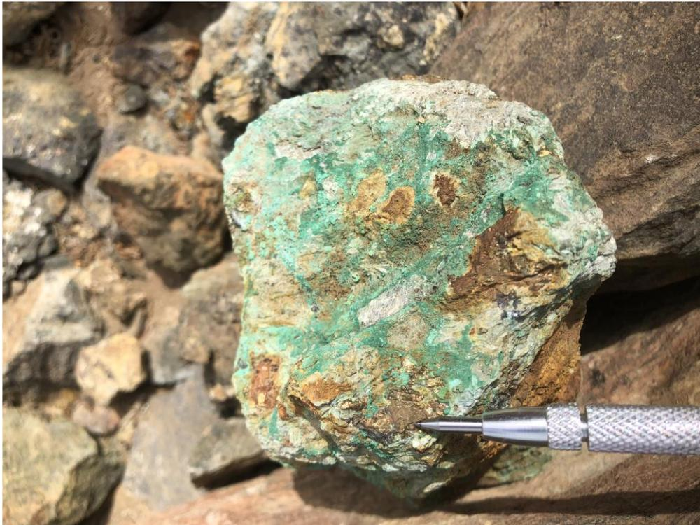
**Figura 20:** Muestra de la zona supérgena con oxidados de cobre, limonitas y sulfuros relictos.
