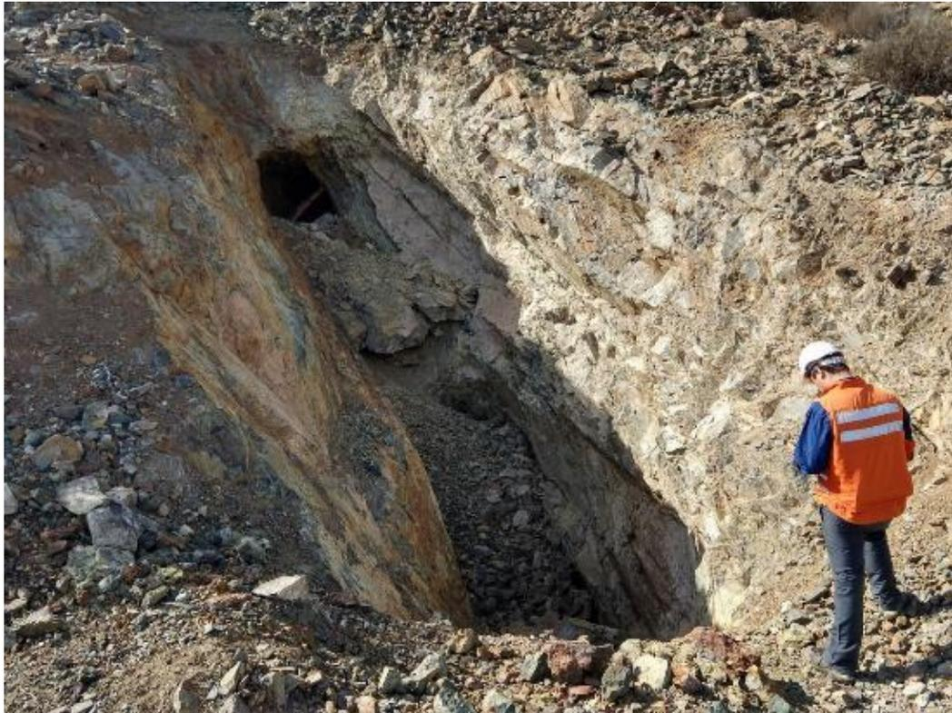
**Figura 12:** Imagen de un pique de explotación de óxidos de cobre asociada a una veta de orientación N65°W/60°SW.
