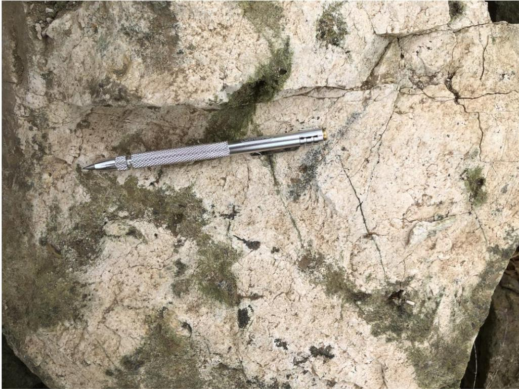
**Figura 14:** Alteración calco-sódica pervasiva con albita y epidota y menor actinolita.
