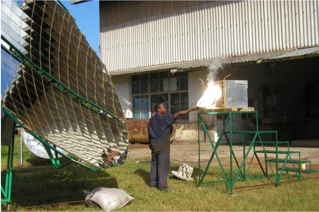
Figura 2.12 Reflector Scheffler construido en Zanzibar, Tanzania. Recuperada de: https://www.terra.org/categorias/articulos/cocinar-con-el-sol
