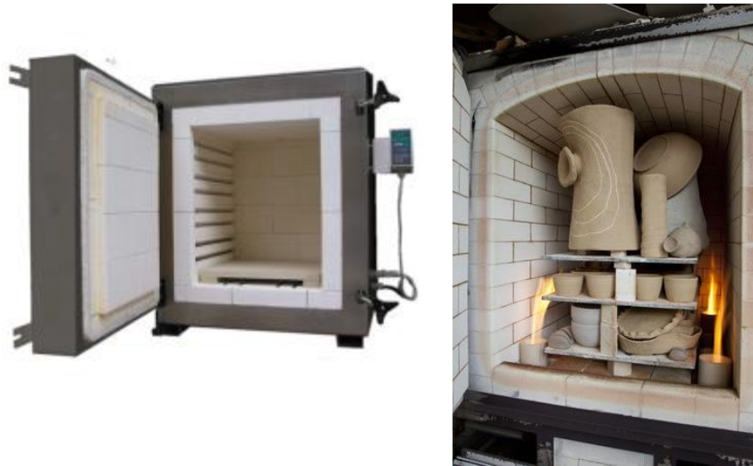
Figura 2.18 A la izquierda un horno eléctrico de cámara y a la derecha un horno de Gas
