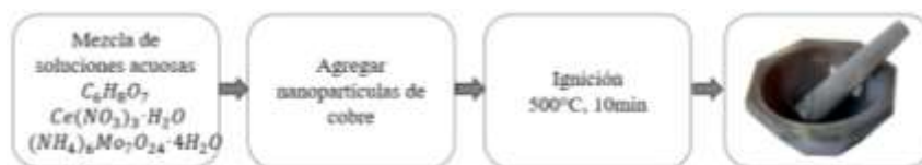
Figura 21 Diagrama del método de combustión convencional
