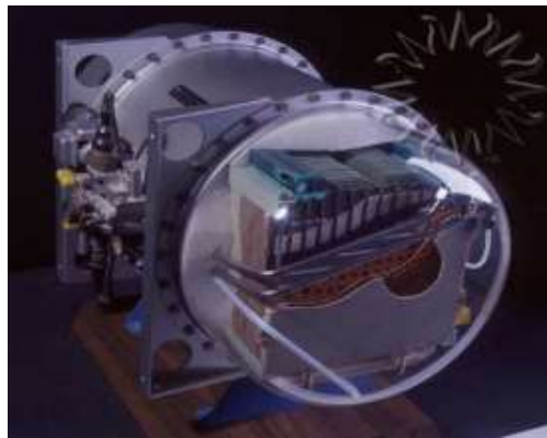
Figura 11 Sección de celda de combustible usada en Géminis V [35]
