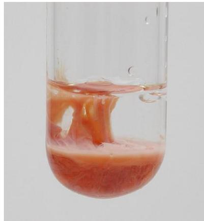
**Figura N°9:** Precipitado naranja formado al mezclar Clorhexidina con Hipoclorito de sodio (Haapasalo y cols., 2010)
