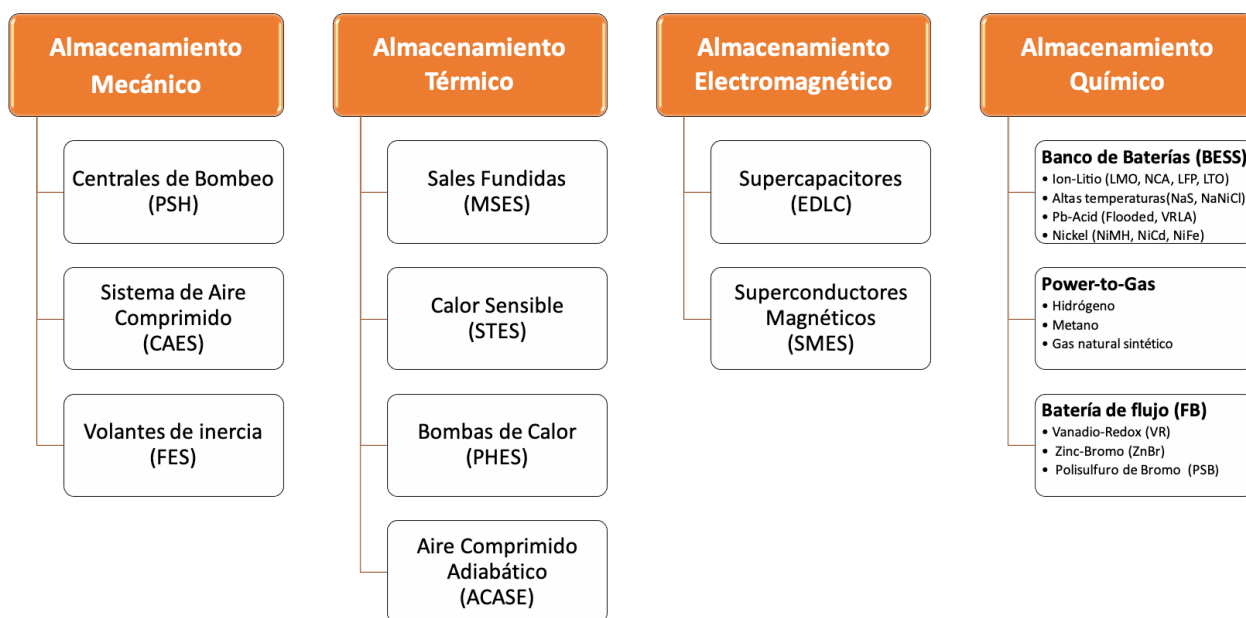
Figura 2.1: Clasificación de las tecnologías de almacenamiento [2] y [9]. Nota: LMO: óxido de litio y manganeso; NCA: óxido de níquel, cobalto y aluminio; LFP: fosfato de litio y hierro; LTO: titanato de litio; NaS: azufre de sodio; NaNiCl: cloruro de níquel sódico; VRLA: plomo-ácido regulado por válvula; NiMH: níquel-hidruro metálico; NiCd: níquel cadmio; NiFe: níquel hierro.
