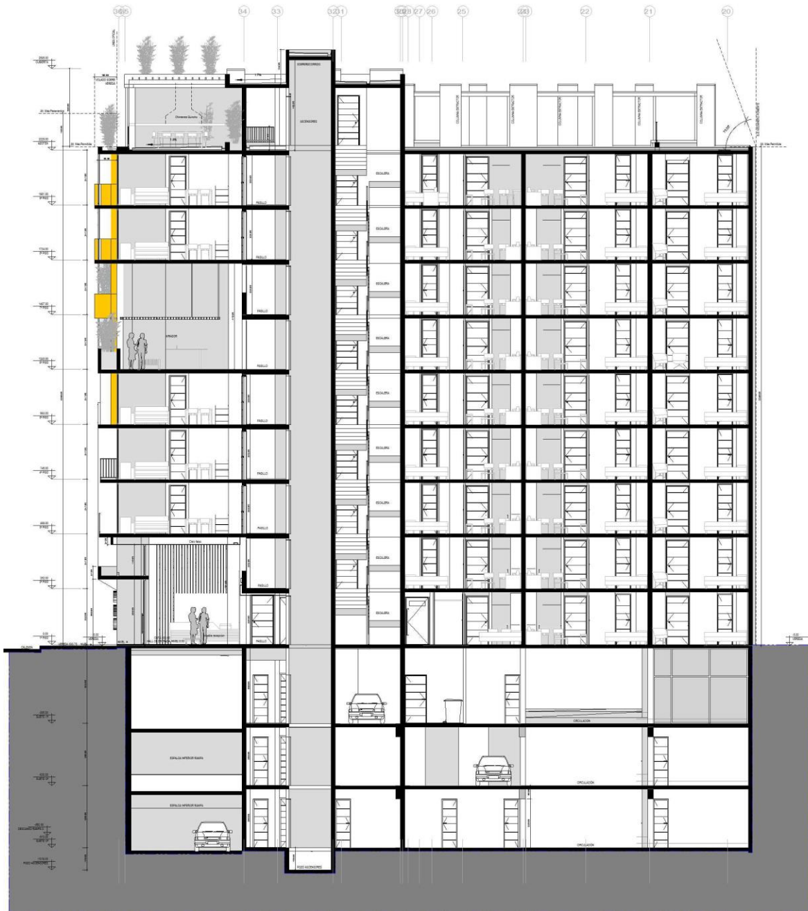
CORTE 2. - Corte transversal Oriente-Poniente. Ubicación de doubles alturas Hall de Acceso, Mirador y Quinchos Azotea.
