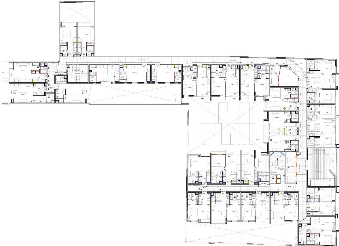
PLANTA PISO 2° . – Indicación de subdivisión de tabiques certificados para departamentos y espacios comunes
