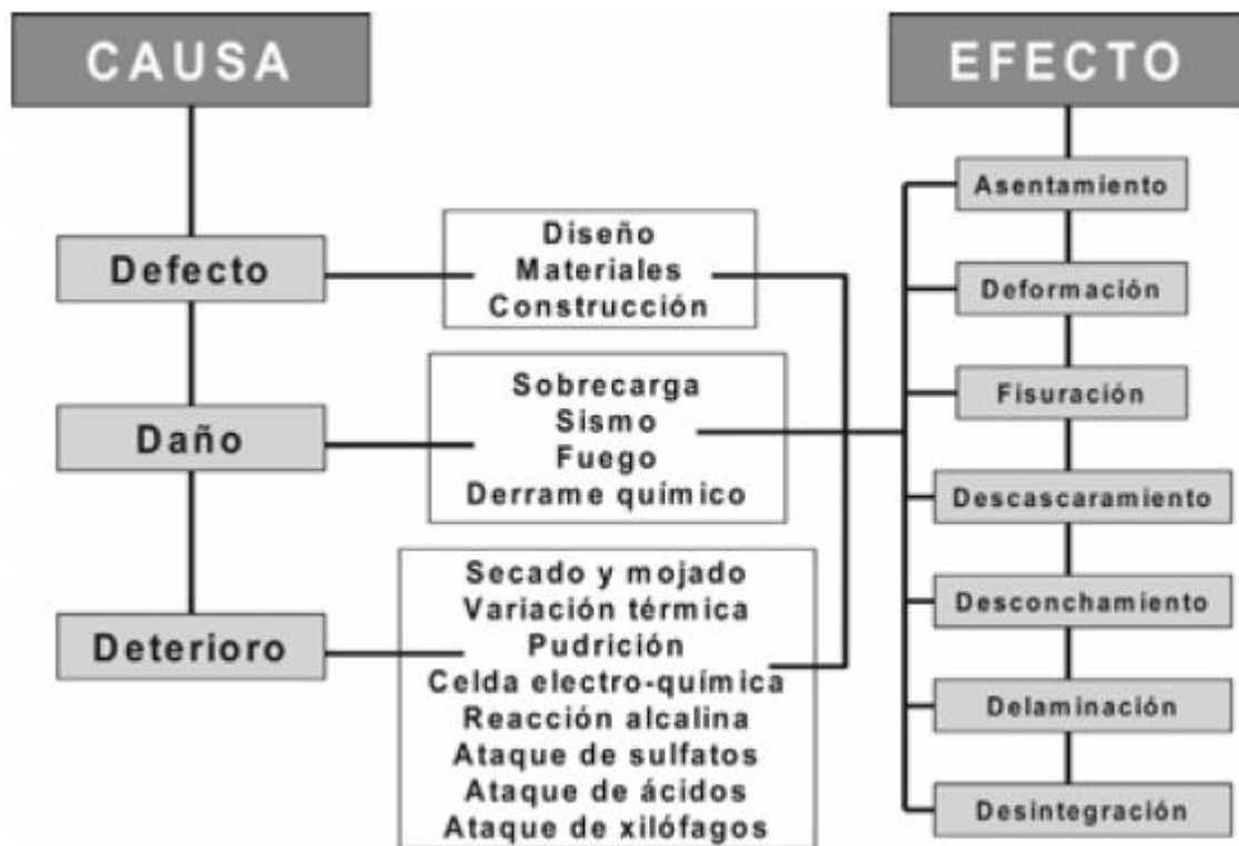
Figura 2: Causas y efectos de las principales manifestaciones patológicas estructurales [7]
