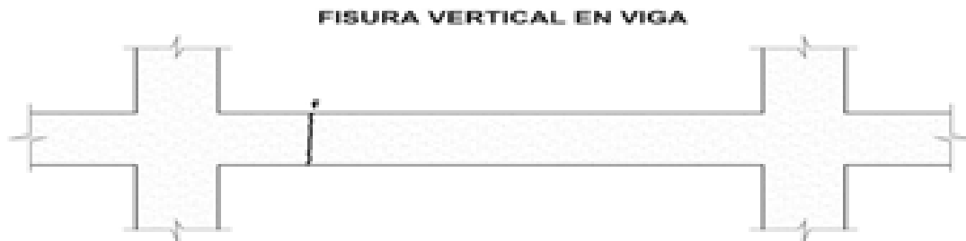
Figura 43: Fisura vertical en viga sometida a flexión [7]
