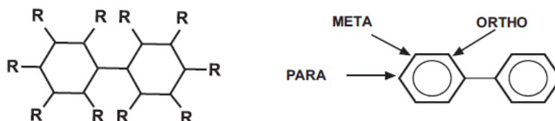
Figura 1.1: Estructura molecular de los PCBs (R: átomos de cloro) y esquema de las posibles orientaciones de los átomos de cloro en los anillos de bifenilo. [CONAMA, 2004]
