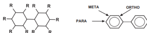
Figura 1.1: Estructura molecular de los PCBs y esquema de las posibles orientaciones de los átomos de cloro [PNUMA, 2004]
