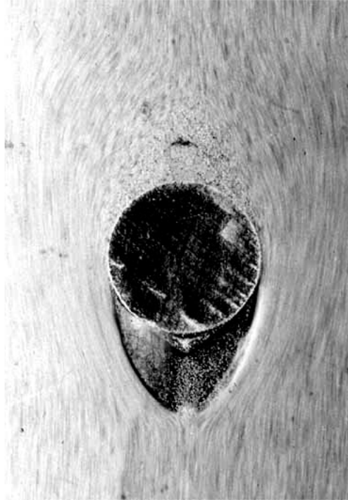
Figura 3.4: Estructura de flujo en el caso de arena fluyendo verticalmente hacia abajo alrededor de un obstáculo. Notar la zona de turbulencia upstream y la zona vacía downstream . Fuente: (Brennen, 2005)
