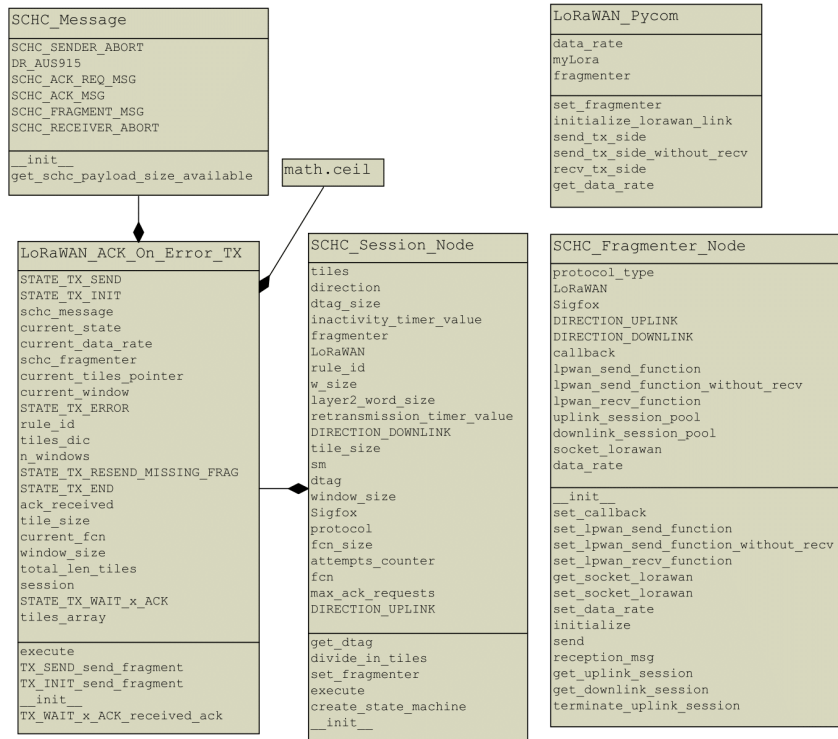
Figura 5.3: Diagrama de Clases módulo PySCHC Node [elaboración propia]
