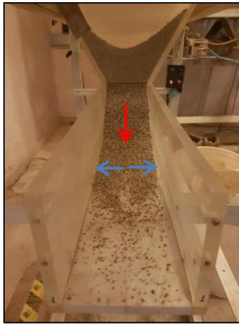
Figura 56: "Ejemplo de perfil de deposición para  $H_f = 10$  [cm] en grupo 3"
