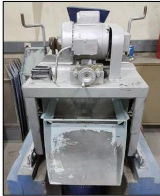
*Figura 61: "Harnero eléctrico con mallas ASTM"*
