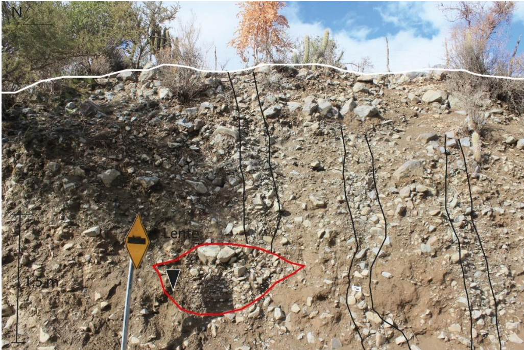
Figura 3.14. Se observa el depósito El Arenal 4 ya descrito, el lente y las franjas clasto soportadas en contraste con su textura matriz soportada.
