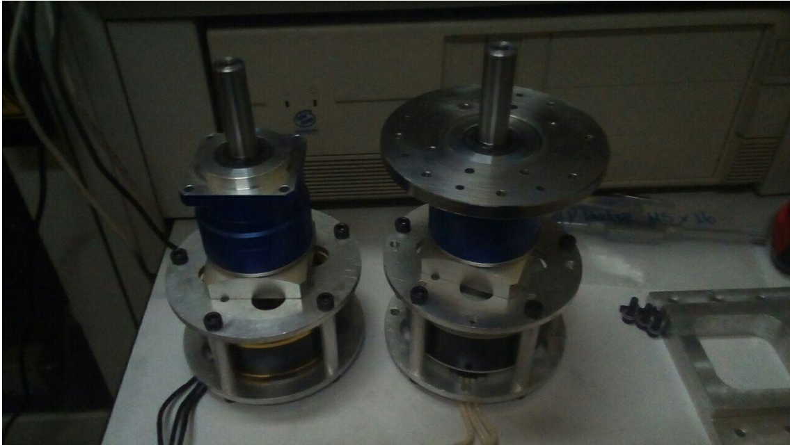
Figura 7.8: Conjuntos motrices del codo y el hombro ensamblados.
