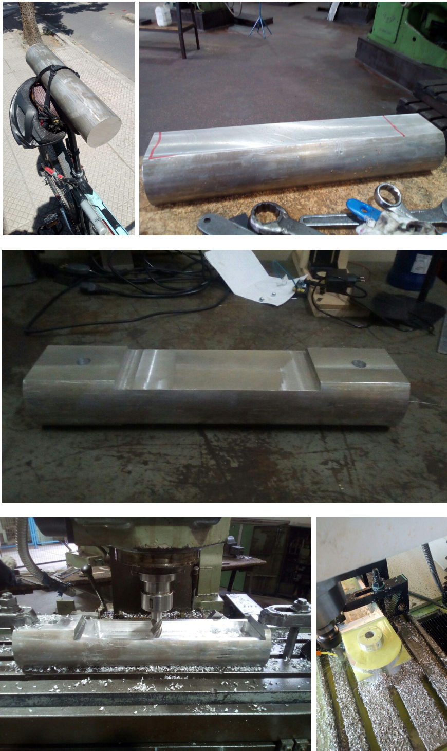
Figura 7.5: Proceso fabricación eslabón húmero.
