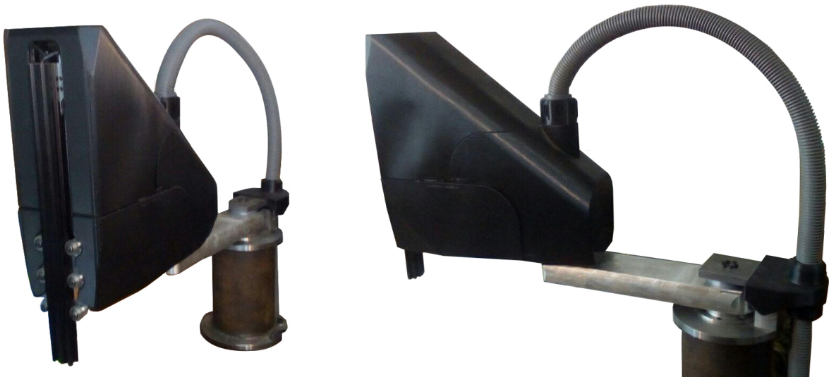
Figura 7.10: Vistas ensamble con carcasa impresa en PLA.
