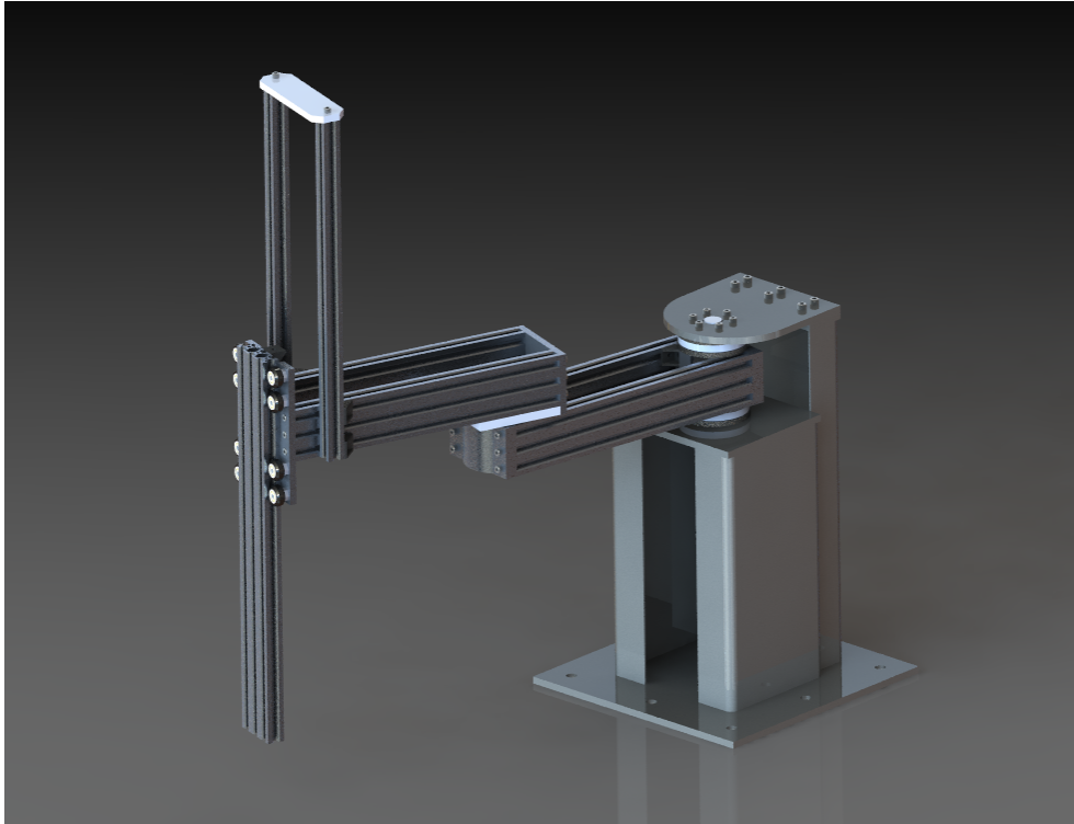
Figura 6.3: Primera iteración de diseño realizada en Solidworks (software CAD).
