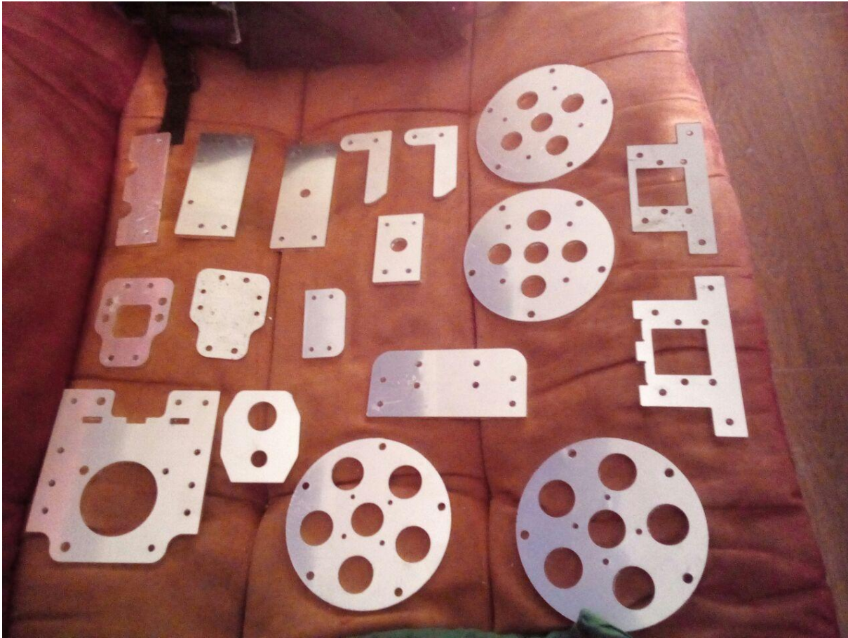
Figura 7.7: Piezas de aluminio AA1100H14 cortadas con laser para armar eslabón radio-cúbito y conjuntos motrices.
