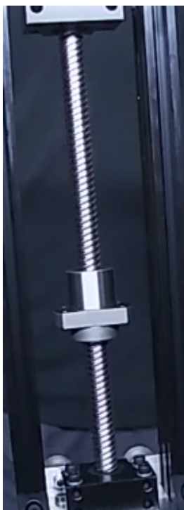
Figura 6.16: Tornillo de bolas SFE1616 instalado.
