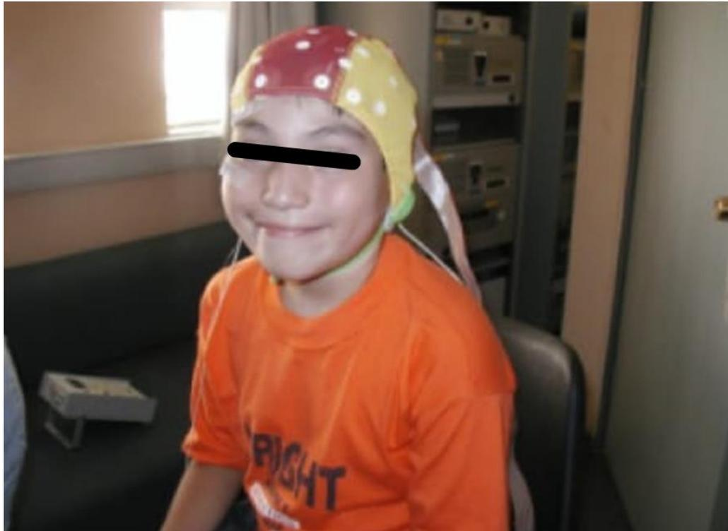
Figura 1.2: Un participante de 10 años, preparado para un registro de EEG en el laboratorio de Sueño y Neurofisiología del INTA. Las posiciones del arreglo de 32 electrodos están fijadas en un casco, y su disposición corresponde a la norma 10/20 Jaspers et al. [25] . En el ojo derecho del participante se registra la actividad ocular utilizando EOG.
