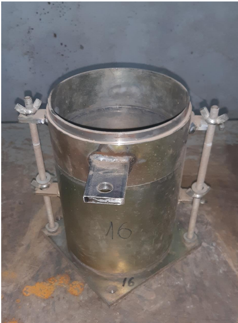
Figura 6.5: Molde y collar para ensayo CBR vibrado, equipo AJGEOTECH.
