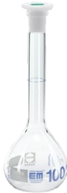
Figura 3.5: Matraz aforado 100 ml con tapón de plástico (IndusLab, 2020).
