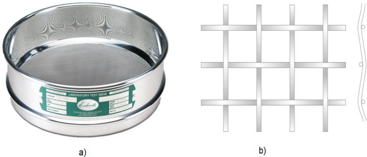
Figura 3.2: a) Tamiz de alambre tejido b) Esquema del tejido simple de los tamices (Endecotts, 2015).
