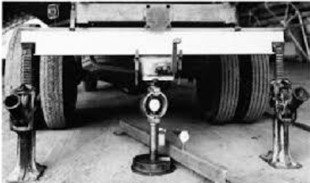
Figura 2.6: Montaje para el ensayo CBR in situ (ASTM D4429, 2009).
