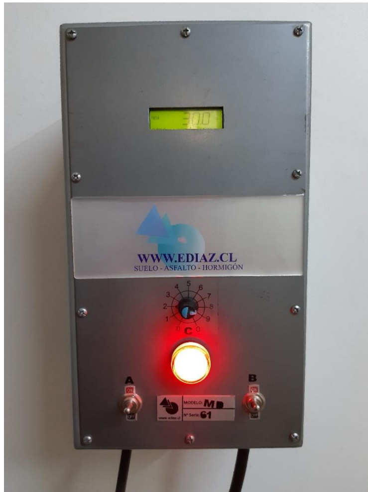
Figura 3.9: Caja control de mesa vibratoria, equipo AJGEOTECH.
