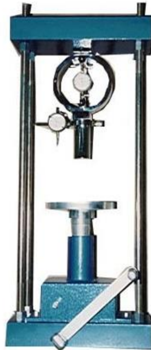
Figura 6.2: Razón de soporte, CBR, para una densidad específica.
