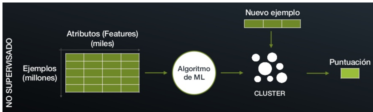
Figura 2.4: Mecanismo de los algoritmos de aprendizaje no supervisado [6].
