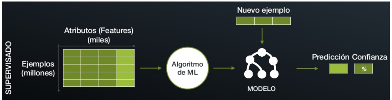
Figura 2.3: Mecanismo de los algoritmos de aprendizaje supervisado [6].
