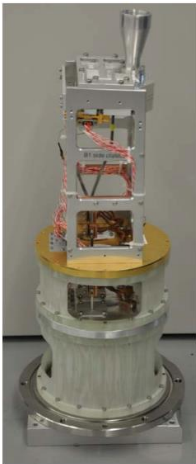
Figura 4. Cartucho conteniendo un front-end típico [2].
