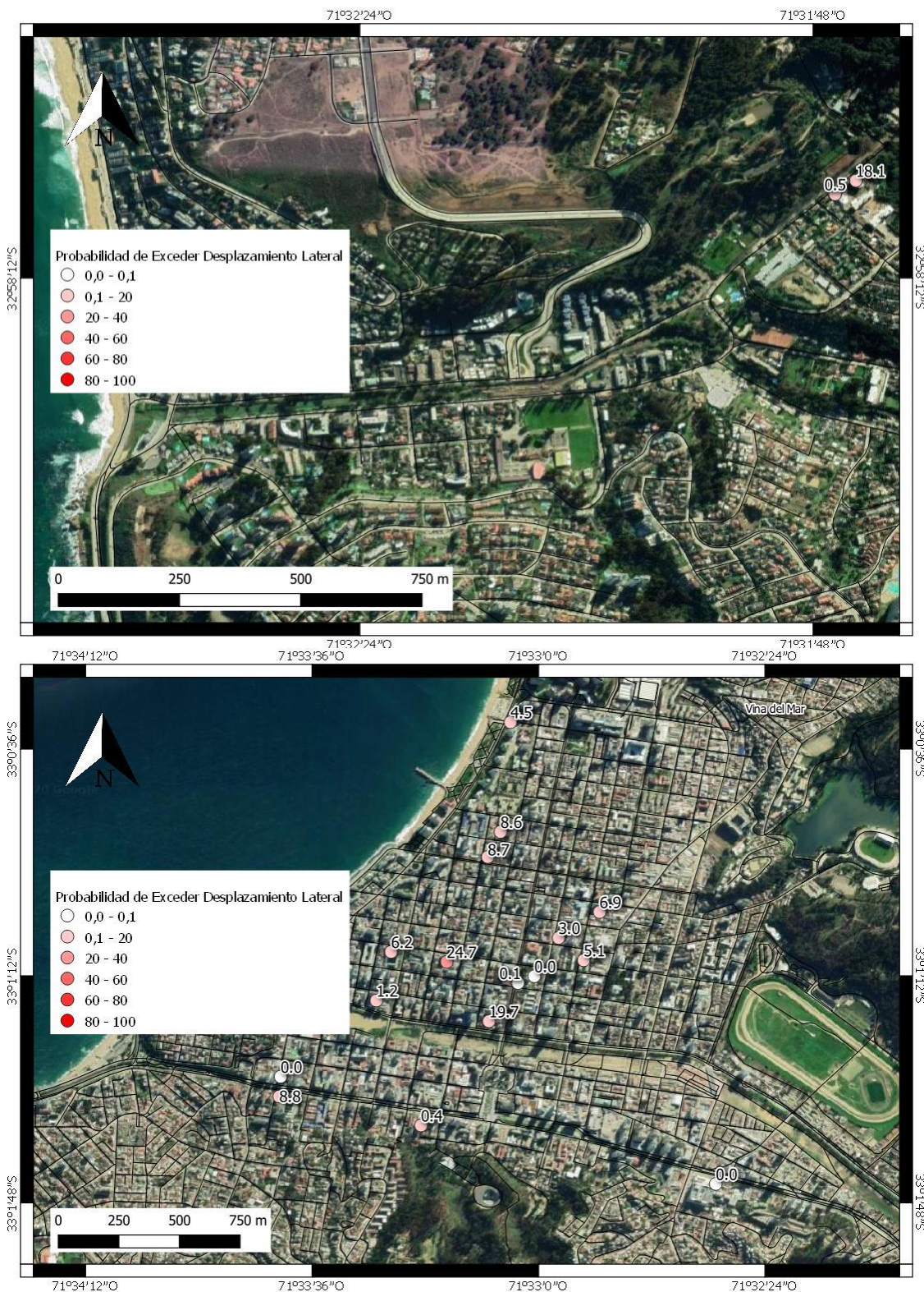
Figura 5.48: Probabilidad de exceder un desplazamiento lateral de 3 [m], en porcentaje. (Escala 1: 5.000 y 1:10.000 respectivamente)
