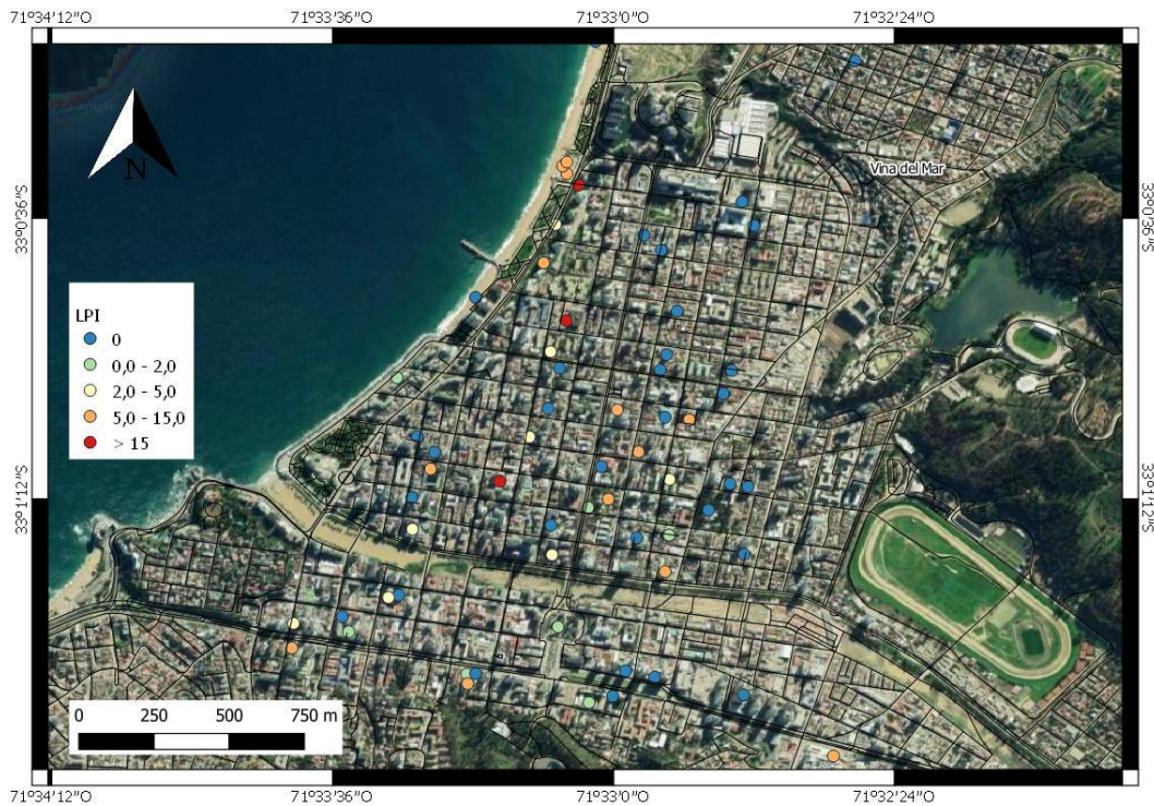
Figura 5.52. LPI considerando el sismo de 2010. (Escala 1:10.000)
