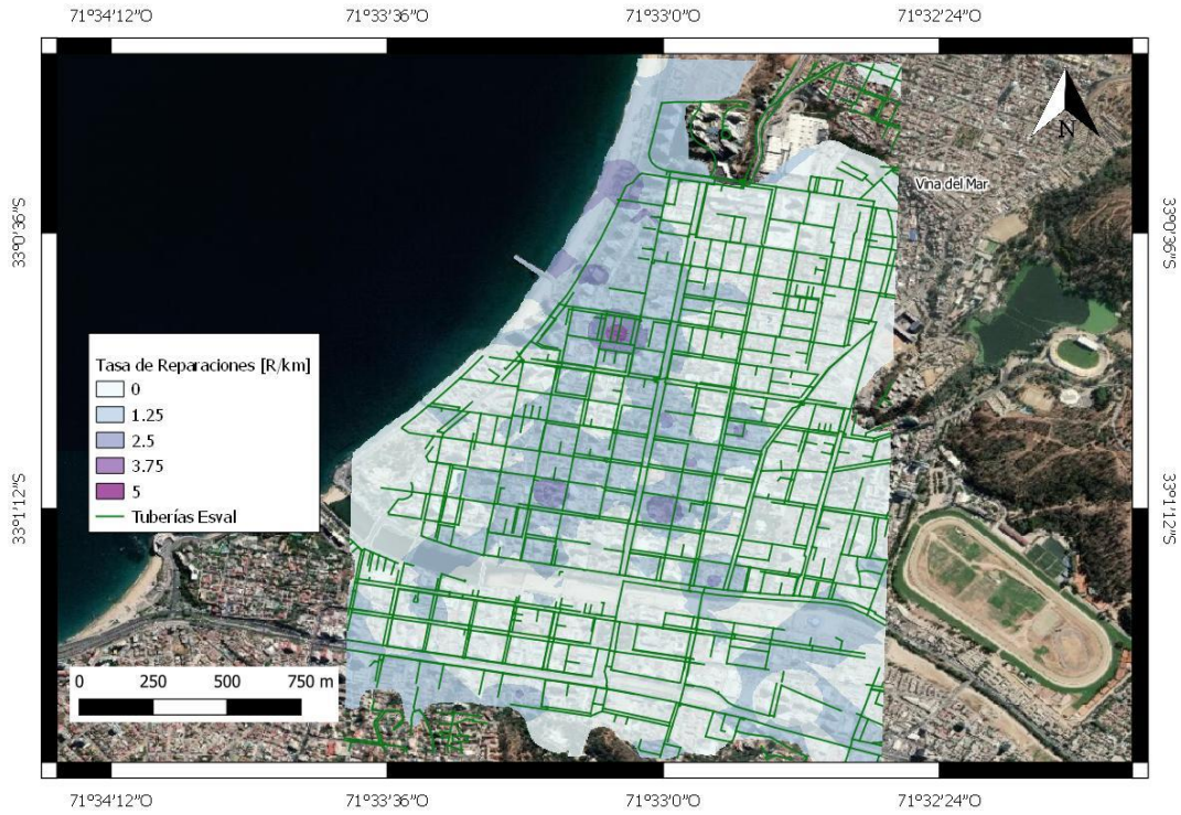
Figura 5.56: Tasa de reparaciones considerando tuberías de PVC para el escenario sísmico 3 considerando valores de LPI y probabilidad de licuación del 85%. (Escala 1:10.000)
