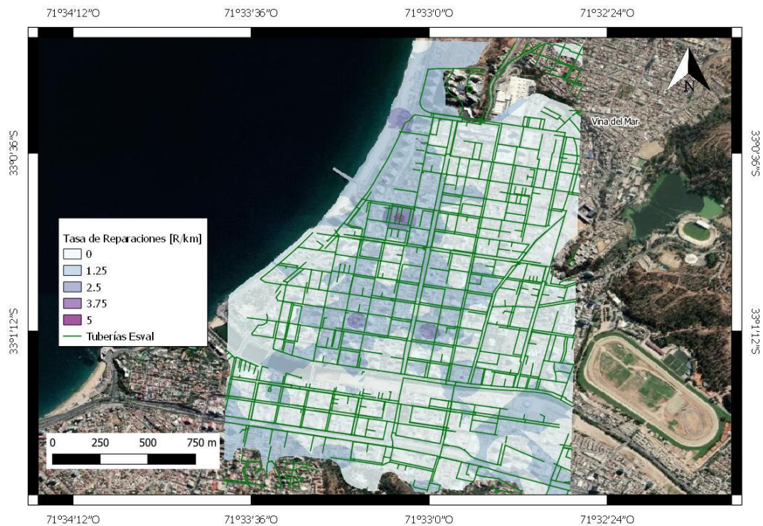
Figura 5.55: Tasa de reparaciones considerando tuberías de PVC para el escenario sísmico 3 considerando valores de LPI y probabilidad de licuación del 50%. (Escala 1:10.000)
