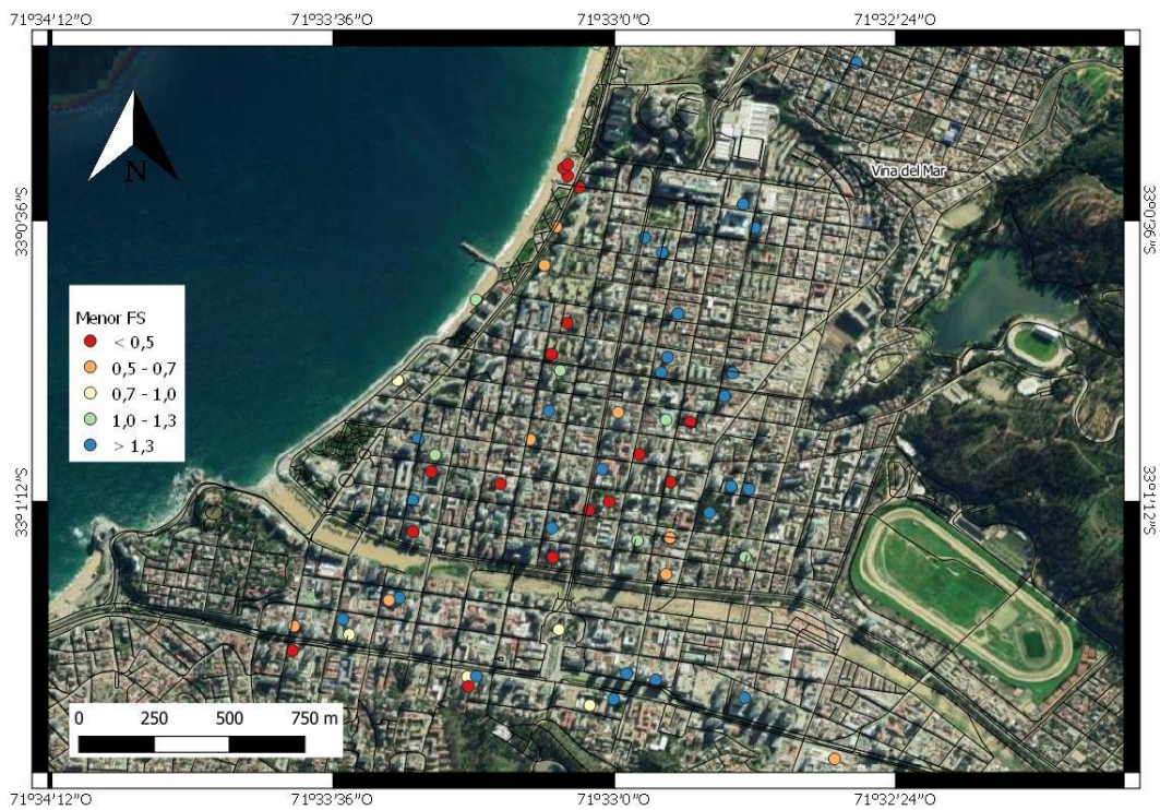
Figura 5.51. Menor factor de seguridad ante la licuación considerando el sismo de 2010. (Escala 1:10.000)
