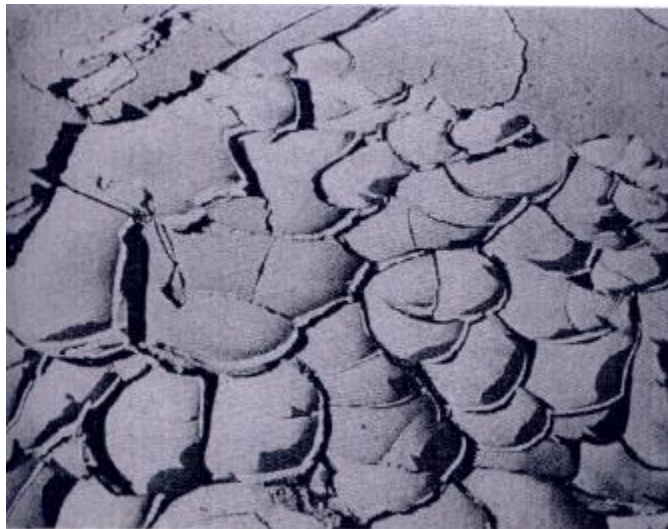
Figura 3.10: Grietas de desecamiento en suelo arcilloso situado sobre estrato limoso. (Varela y Vicencio, 1965)
