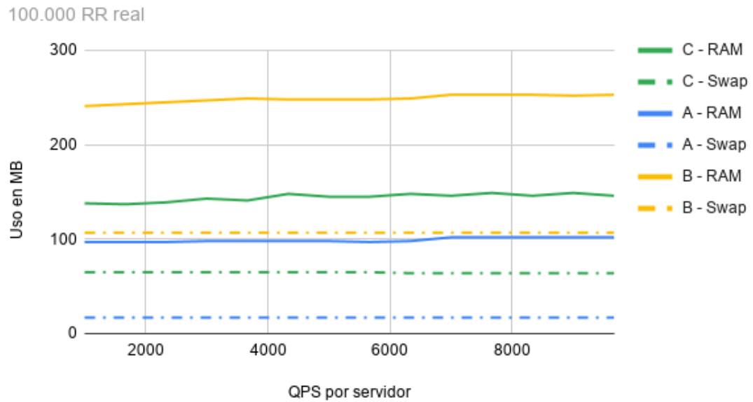
Figura 7.8: Evolución del uso de memoria para Knot y 100.000 RR reales en hosting.
