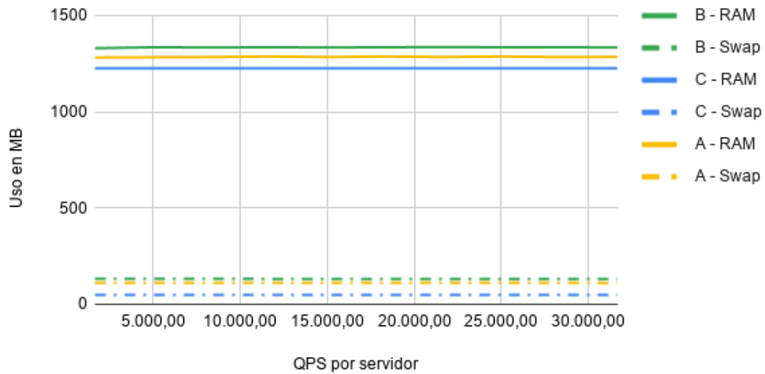
Figura 7.21: Evolución del uso de memoria para Nsd y 2.000.000 RR sintéticos en hosting.
