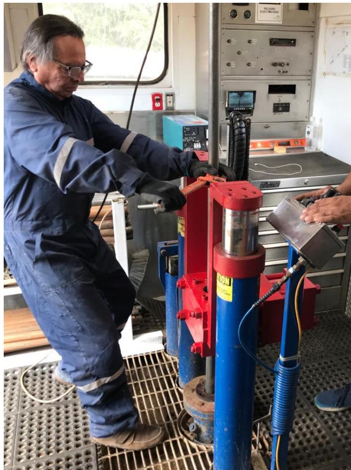
**Figura 18: Ejecución de ensayo CPT.**
