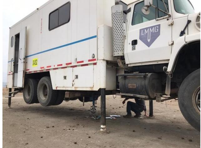
Figura 38: Camión CPT levantado, visto desde lejos, con equipo CBR de terreno montado.
