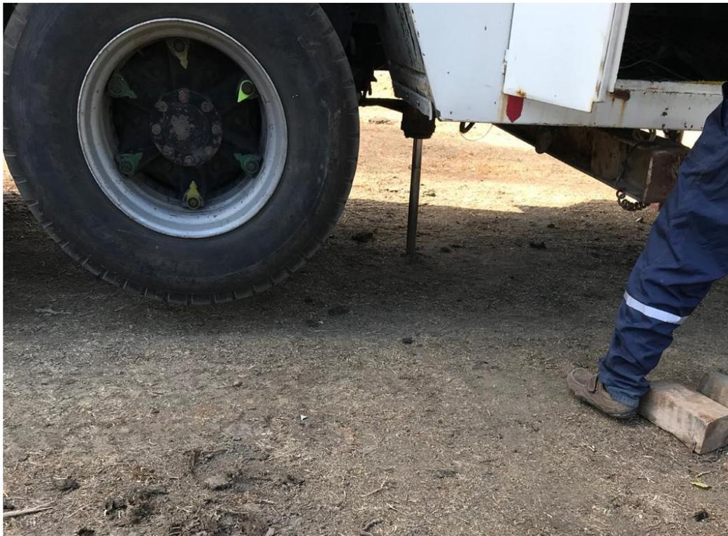
**Figura 19: Cono penetrando estrato superficial del suelo.**
