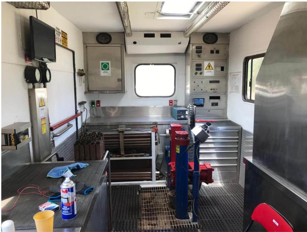
**Figura 16: Interior de camión CPT.**
