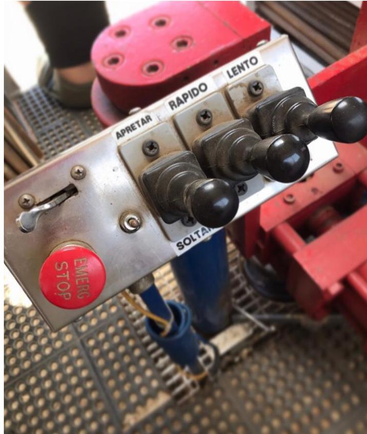
**Figura 17: Panel de control prensa hidráulica.**
