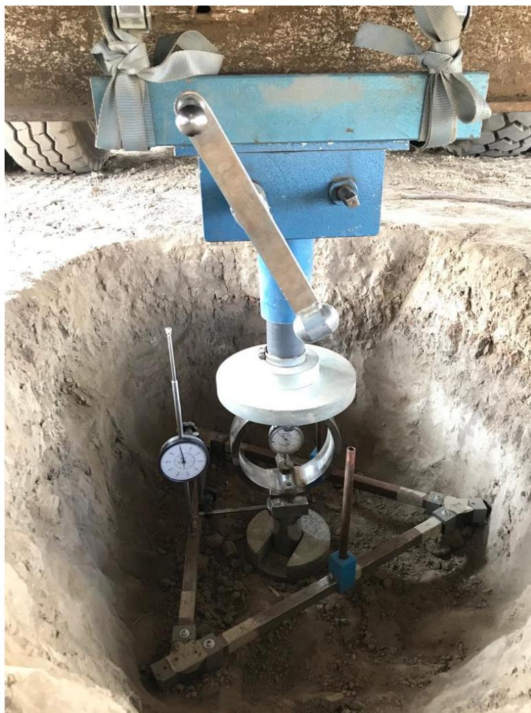
**Figura 14: Equipo CBR en profundidad preparado en terreno.**
