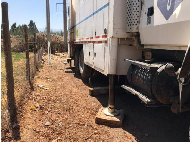
Figura 37: Plataformas soportantes de madera de camión CPT.
