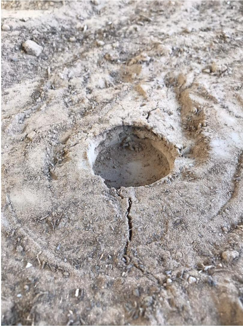
**Figura 13: Suelo deformado media pulgada por ensayo CBR.**
