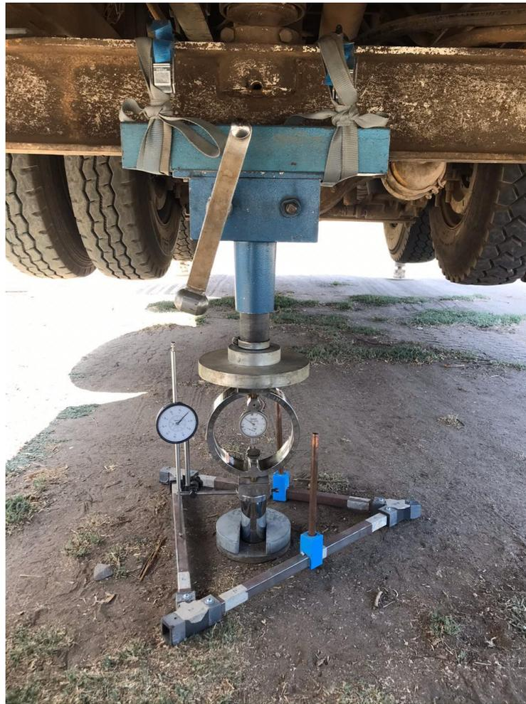
**Figura 11: Equipo CBR preparado en terreno, bajo el camión CPT.**
