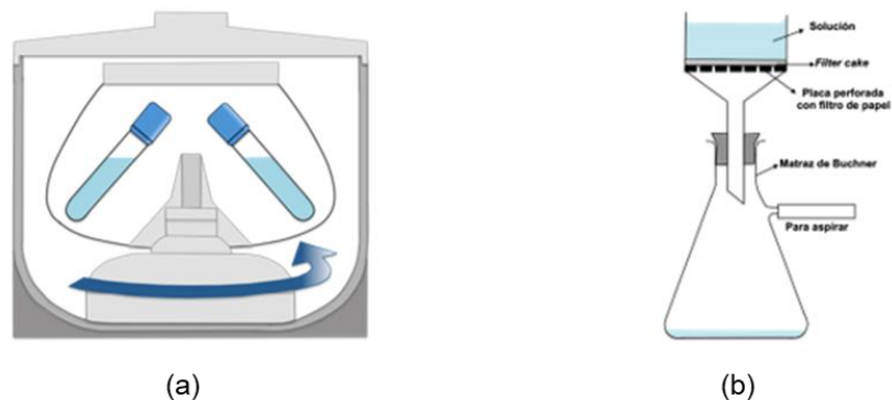
Figura 2-8: (a) Esquema del proceso de centrifugado de la suspensión de laponita y (b) Esquema del proceso de filtrado de la suspensión a través de un filtro de torta o filter cake .
