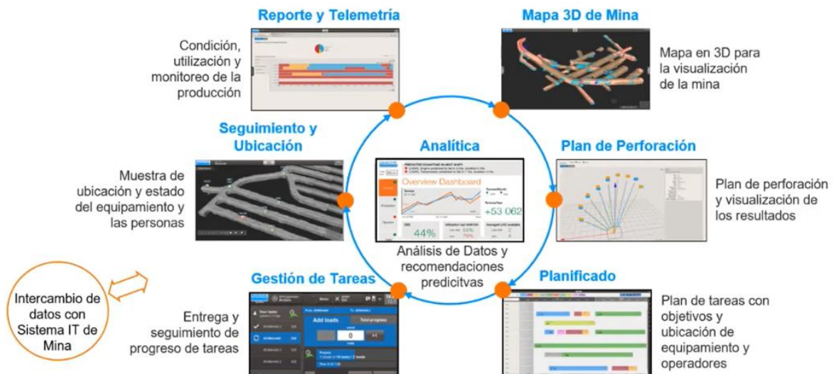
Figura 43 Visualización digitalización del ambiente de Sandvik.
