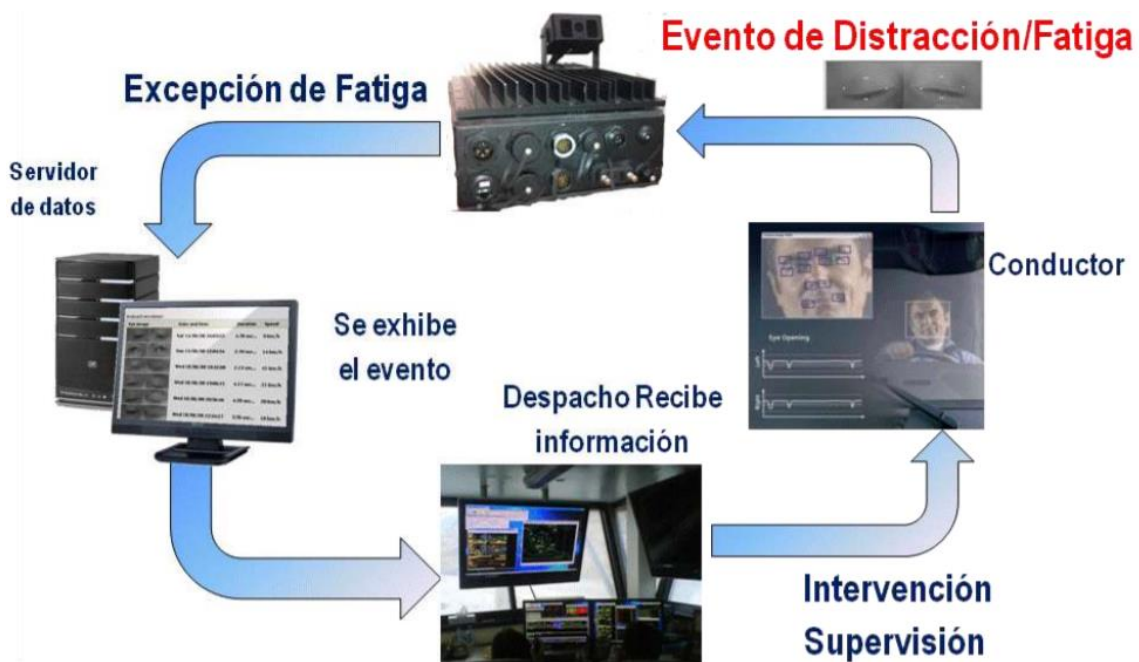
Figura 96 Diagrama básico de Sistema de monitoreo de fatiga.
