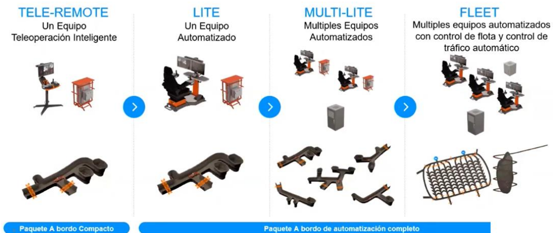
Figura 44 Automatización subterránea para camiones y LHD de Sandvik.
