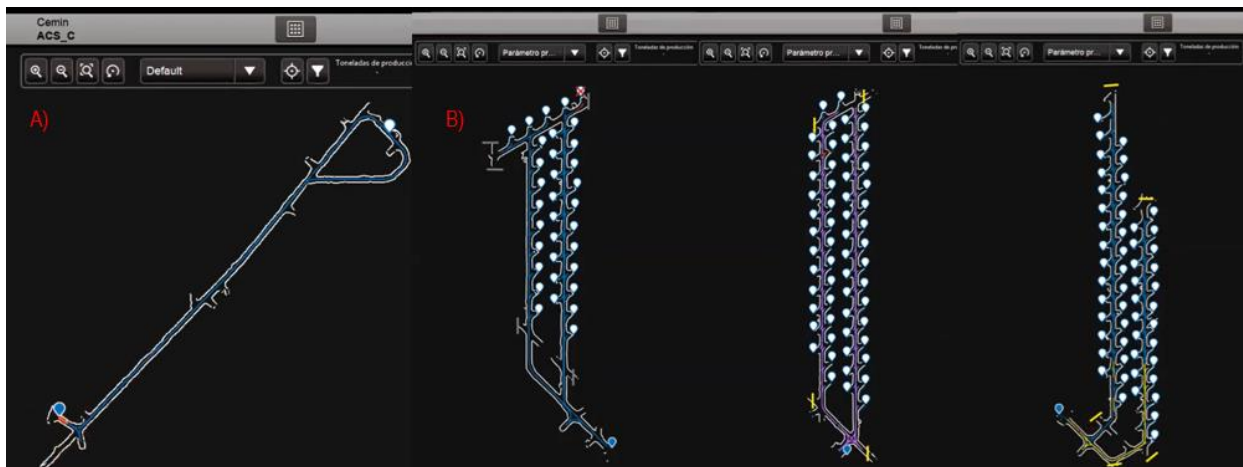
Figura 94 Esquemas de automatización con Optimine de Sandvik: A) Loop Camión mina UVA; B) 3 LHD en Diablo Regimiento, El Teniente.
