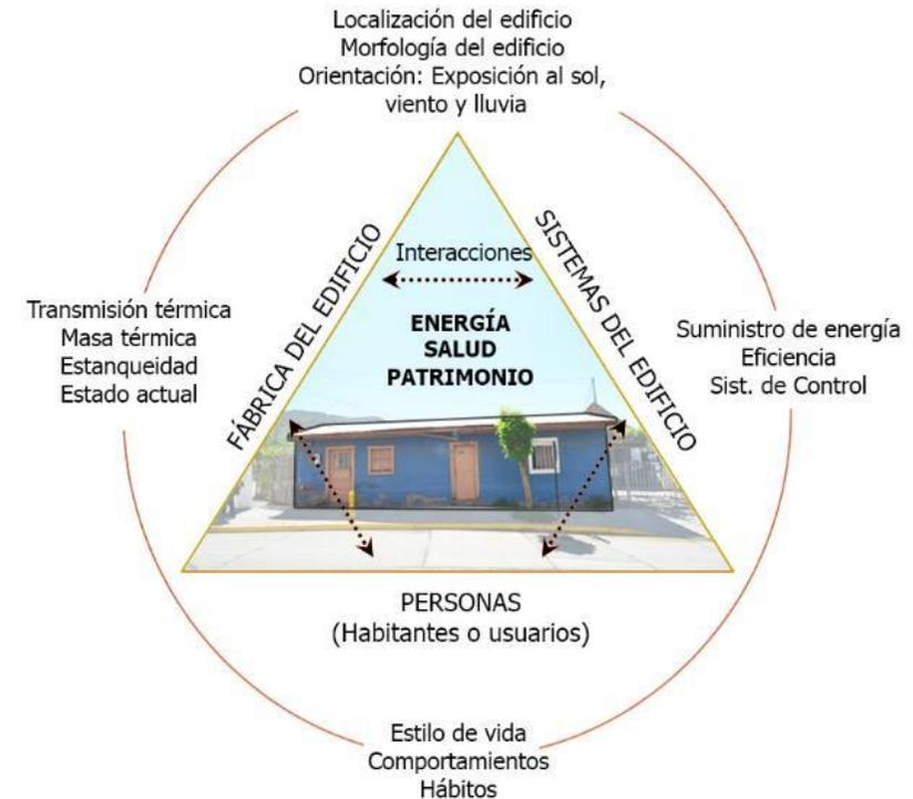
Figura 18: Síntesis gráfica de factores que inciden en el comportamiento energético del edificio
