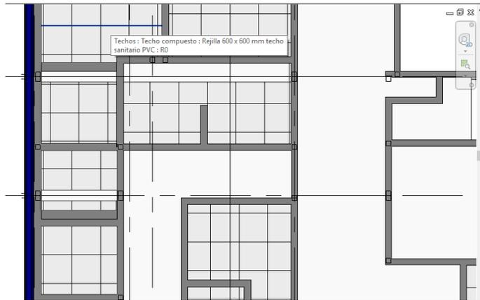
*Imagen 38. Franjas de cielos continuos en cielos desmontables en la unión de los módulos. Elaboración propia.*
