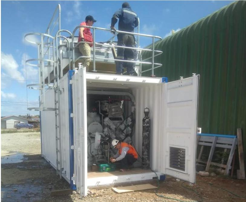
*Foto 21 Solución industrial de modulo frigorífico para la fabricación de hielo, industria salmonera. Empresa Sur Proyecta Puerto Montt. Fuente Elaboración propia.*
