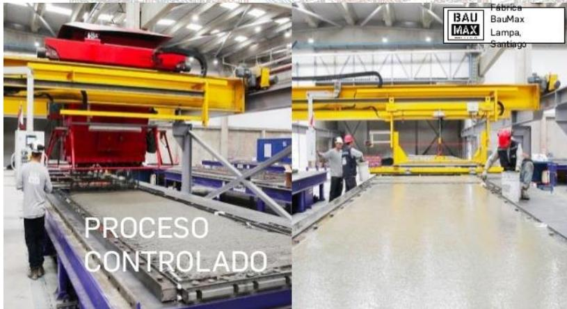
Foto 6 Planta robotizada en la elaboración de prefabricado hormigón BAUMAX. Fuente página web BAUMAX.
