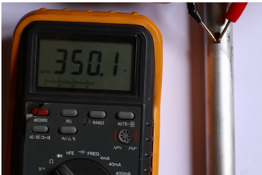
Figura 5.7: Verificación de la resistencia del strain gage .
