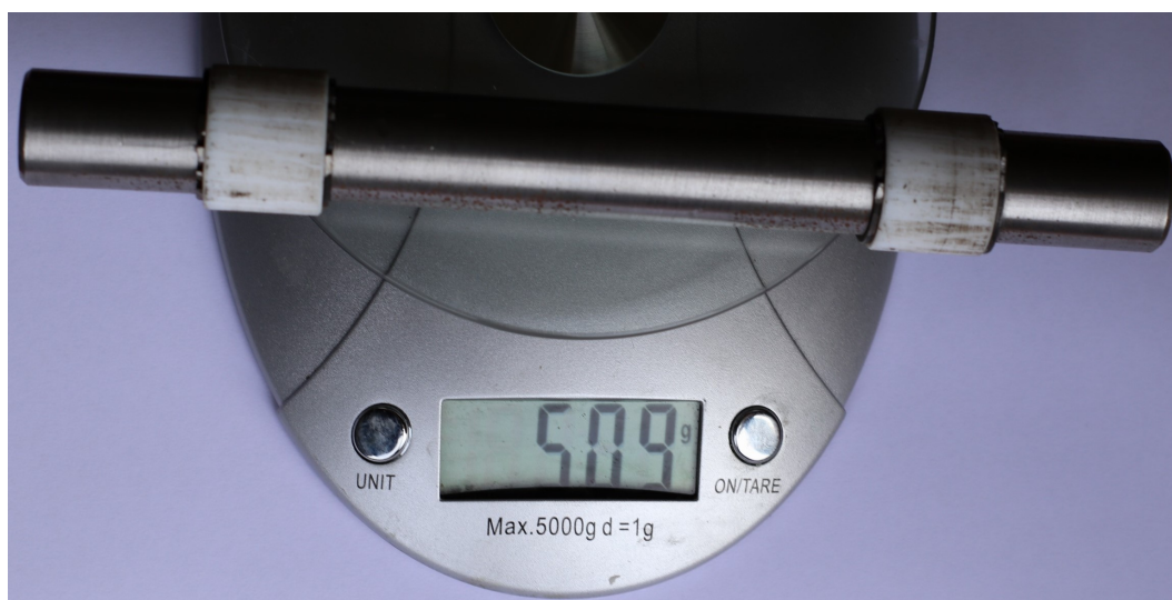
Figura C.7: Medición de masa del striker .
