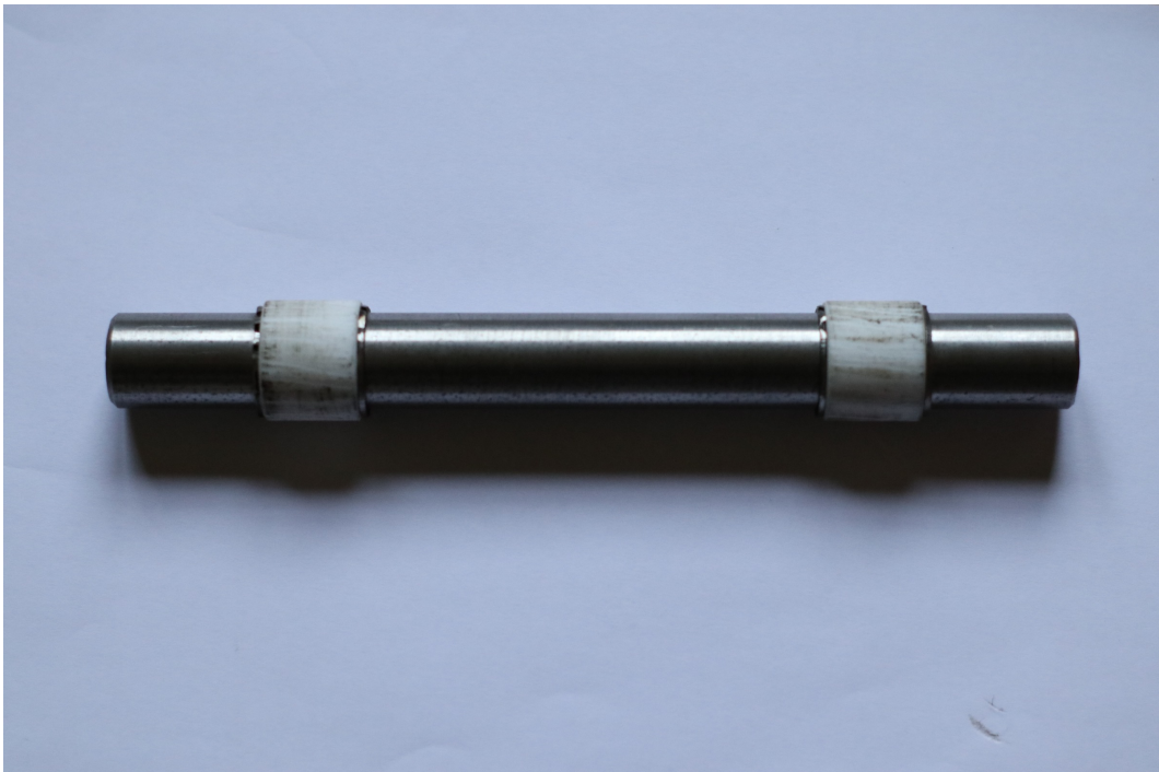
Figura C.6: Striker de acero SAE 1020 con bujes de teflón.
