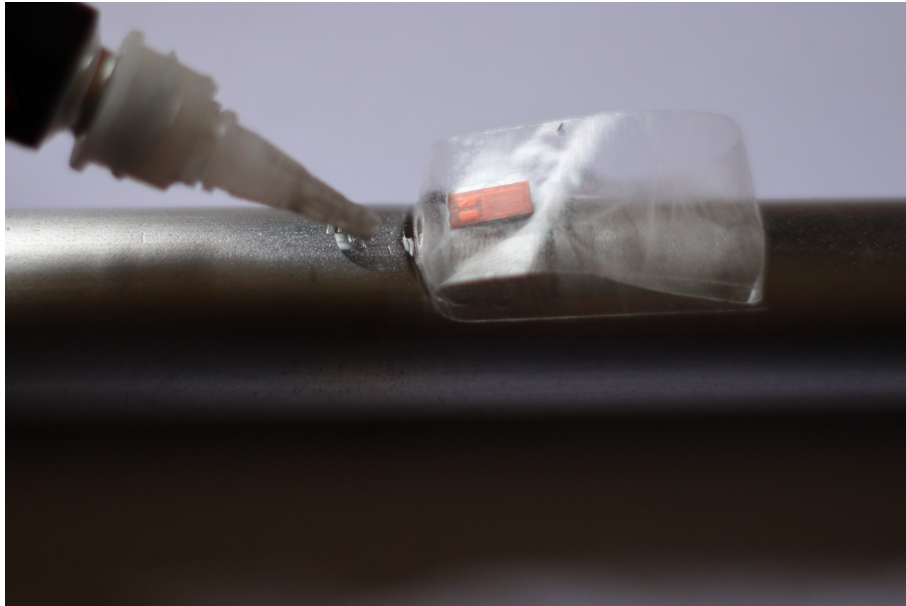
Figura 5.6: Adhesión del strain gage a la superficie de la barra.
