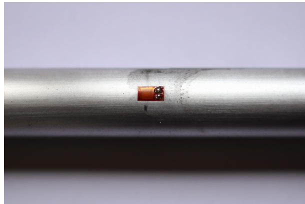
(b) Presoldadura de las pestañas del strain gage .
