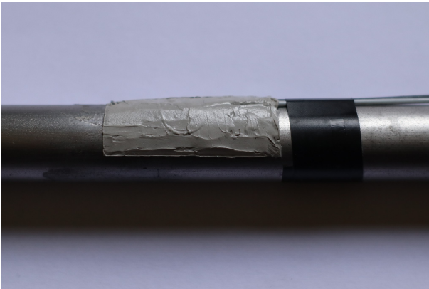
(c) Recubrimiento del strain gage .
