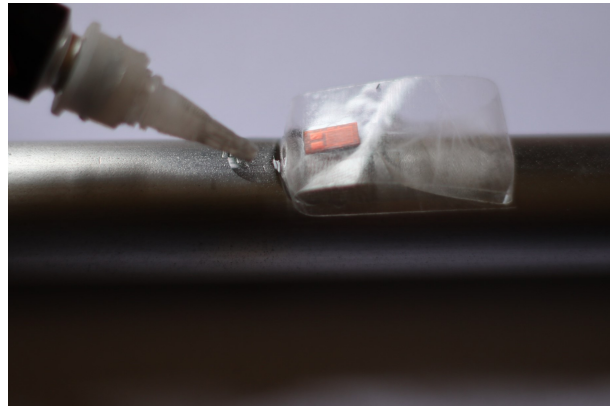
(d) Adhesión del strain gage .
