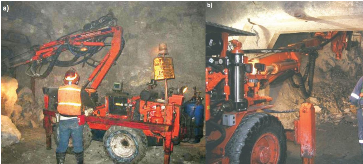
Figura 1: Prácticas de Reducción Secundaria. En a) Reducción de sobre tamaño a través de Command Drill, en b) Descuelgue de punto a través de jumbo de tronadura secundaria (SBU). (Flint et al., 2006)
