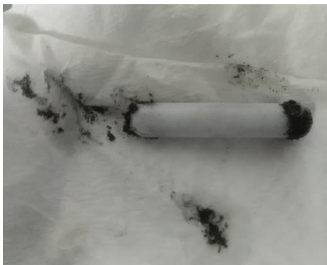
Figura 3.9. Imán con material magnético obtenido luego de sacar muestra de granulometría del vórtice generado por el oscilador magnético.
