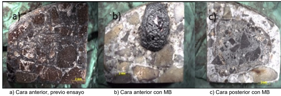
a) Cara anterior, previo ensayo b) Cara anterior con MB c) Cara posterior con MB Figura 136. Resultado de pruebas de ángulo de mojabilidad en refractario MgO realizadas por N. Palma, (Nelson Palma, 2019).
