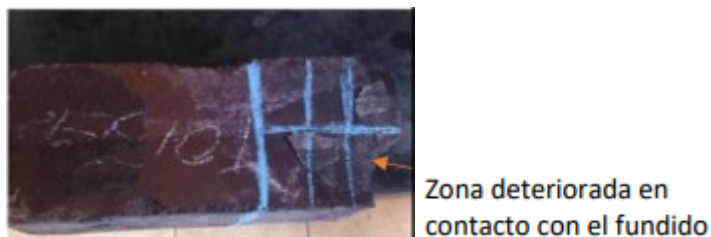
Figura 57 Muestra de ladrillo con uso zona de toberas
