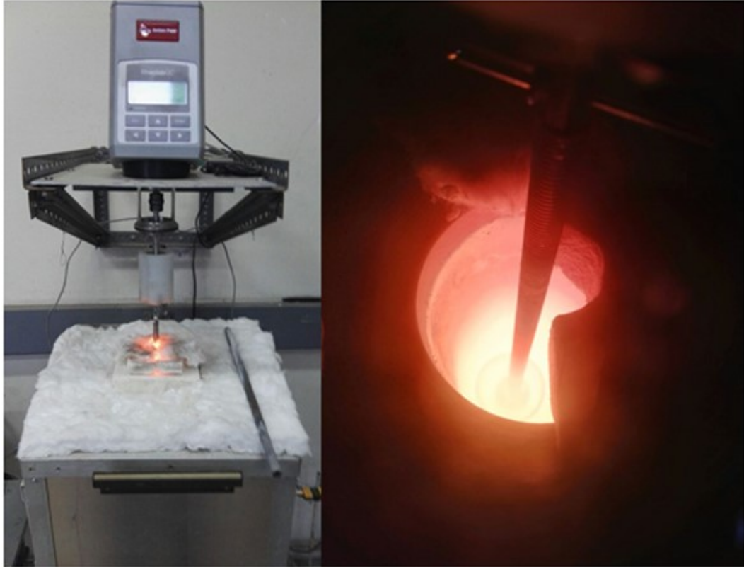
Figura 53 Arreglo experimental. Se observa a la izquierda el sistema de rotación de la probeta al interior del crisol por medio de la barra.
