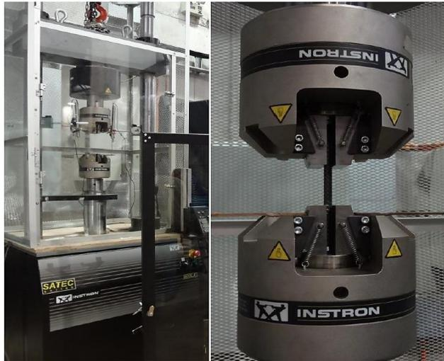
Figura 3.1. Máquina Universal Instron 600LX
