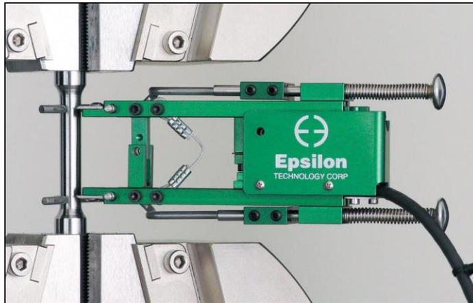
Figura 3.3. Extensómetro axial modelo 3542. (Imagen referencial)
