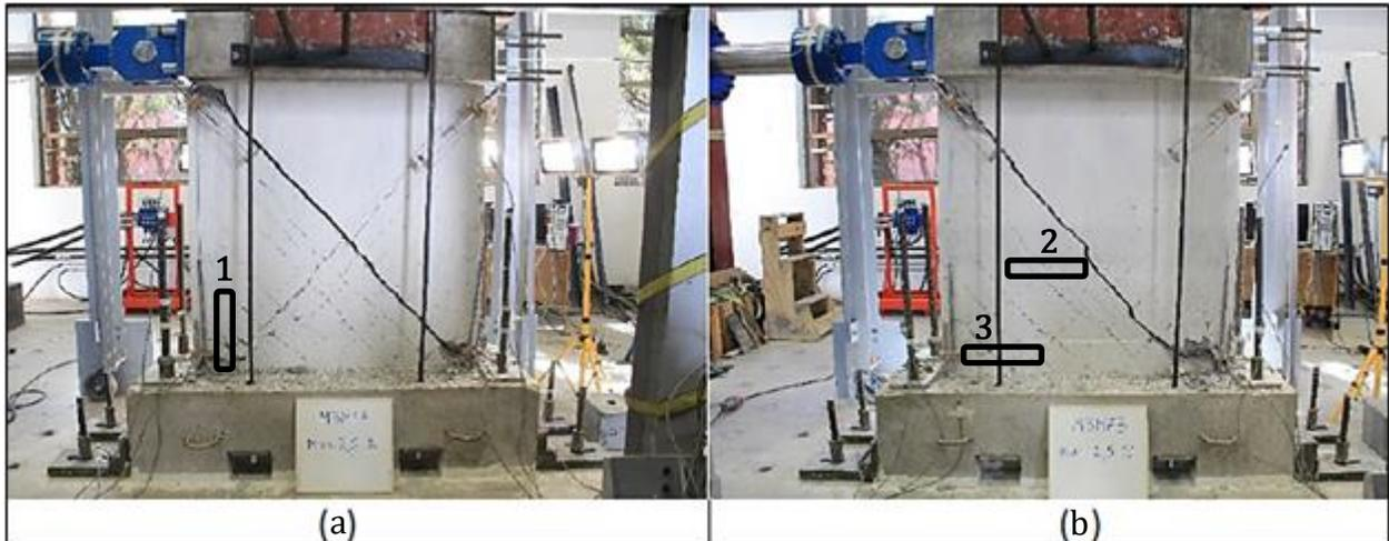
Figura 4.18. Casos especiales barras sobre diagonal opuesta a la de falla. (a) Muro M3MEA, (b) Muro M3MEB.
